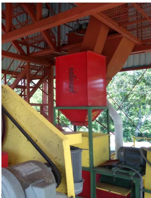
Figura 34. Despulpadora Penagos DVC 306 Beneficio Balcanes.
