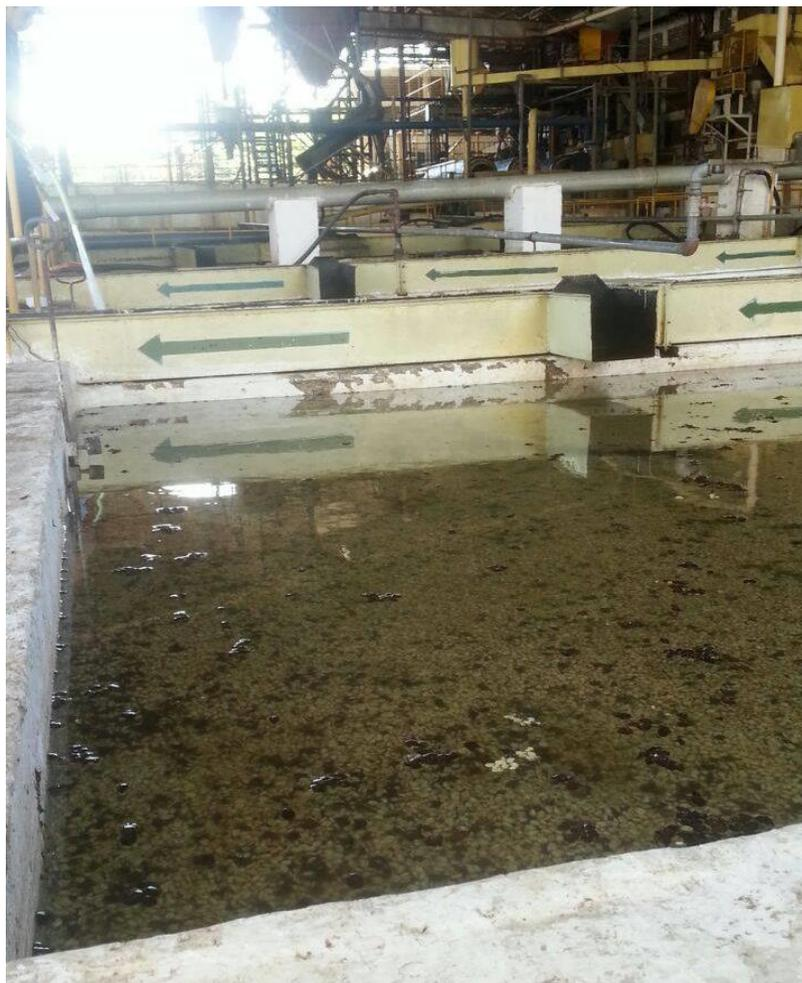
Figura 50. Fermentación en Pila. Fuente: J Hill y CIA, mayo 2019
