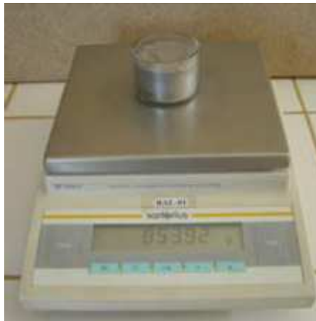
Figura 4.2.3.3.12: Determinación del peso de la taza de vidrio con mercurio residual.
