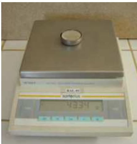
Figura 4.2.3.3.8: Determinación del peso del recipiente de monel con suelo seco.
