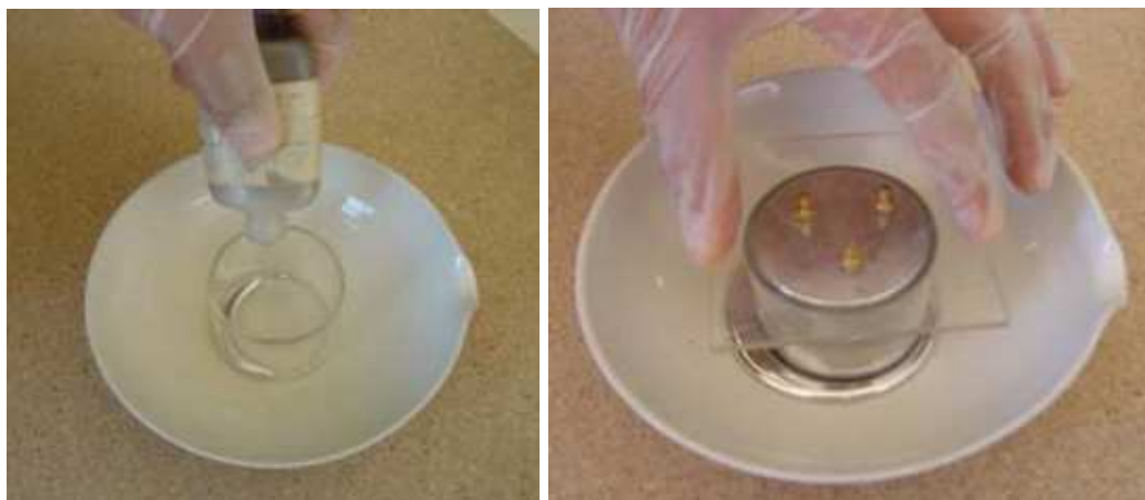
Figura 4.2.3.3.9: Colocación de mercurio en la taza de vidrio.
