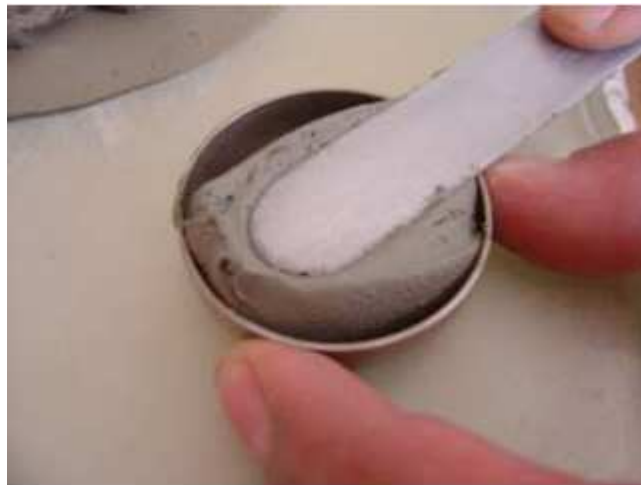
Figura 4.2.3.3.5: Colocación de la muestra en el recipiente de monel.
