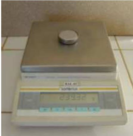
Figura 4.2.3.3: Determinación del peso recipiente de monel con mercurio.
