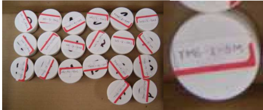
Figura 4.1.2.1: Muestras para ser utilizadas en el ensayo de difracción de Rayos “X”.
