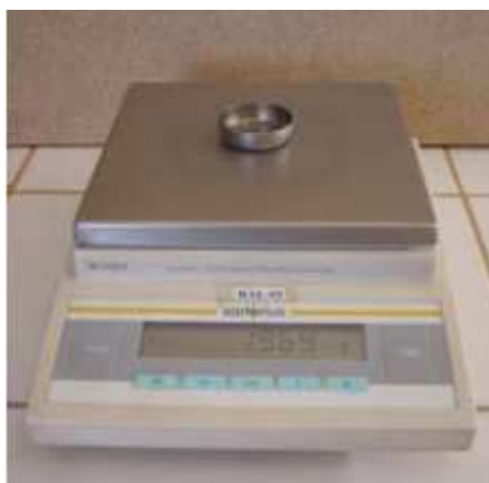
Figura 4.2.3.3.1: Determinación del peso recipiente de monel.
