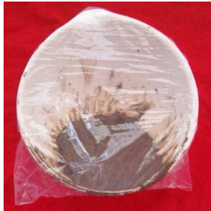
Figura 4.2.1.3.2: Cápsula de porcelana en bolsa plástica para evitar pérdida de humedad
