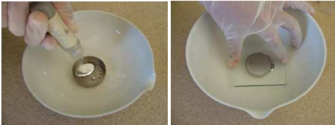
Figura 4.2.3.3.2: Colocación de mercurio al recipiente de monel.
