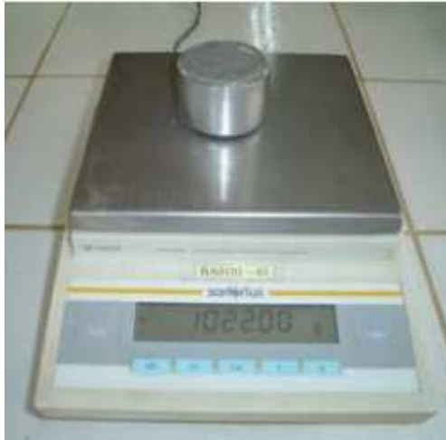
Figura 4.2.3.3.10: Determinación del peso taza de vidrio con mercurio.
