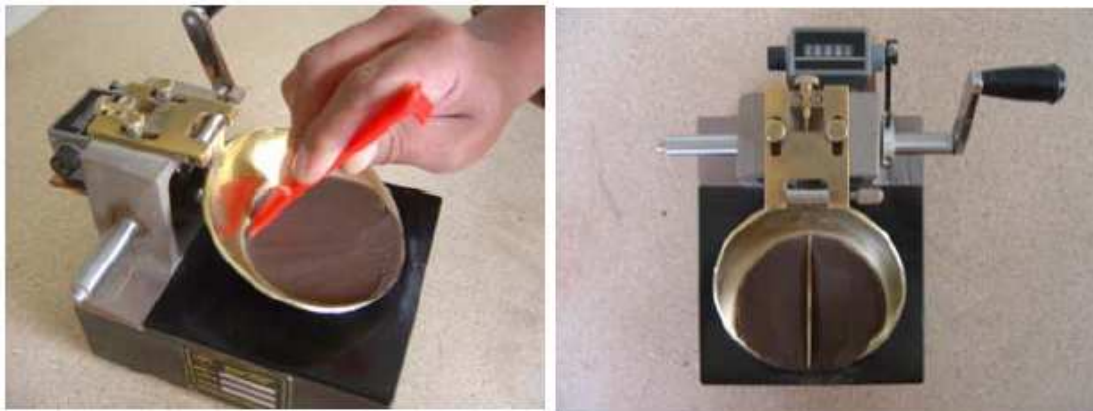
Figura 4.2.1.2.2: Elaboración de ranura en muestra de suelo.
