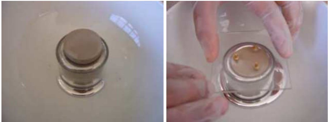
Figura 4.2.3.3.11: Introducción de la pastilla de suelo seco en taza de vidrio con mercurio.
