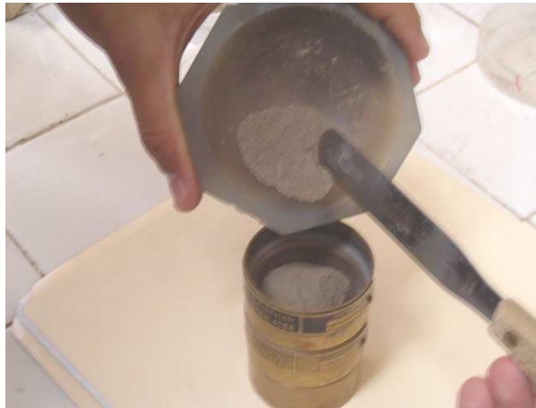
Figura 4.1.2.3: Tamizado de muestras pulverizadas.
