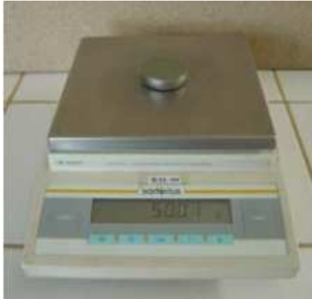
Figura 4.2.3.3.6: Determinación del peso del recipiente de monel con suelo húmedo.
