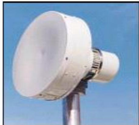
**FIGURA 10 Antenas de enlace de microondas**
