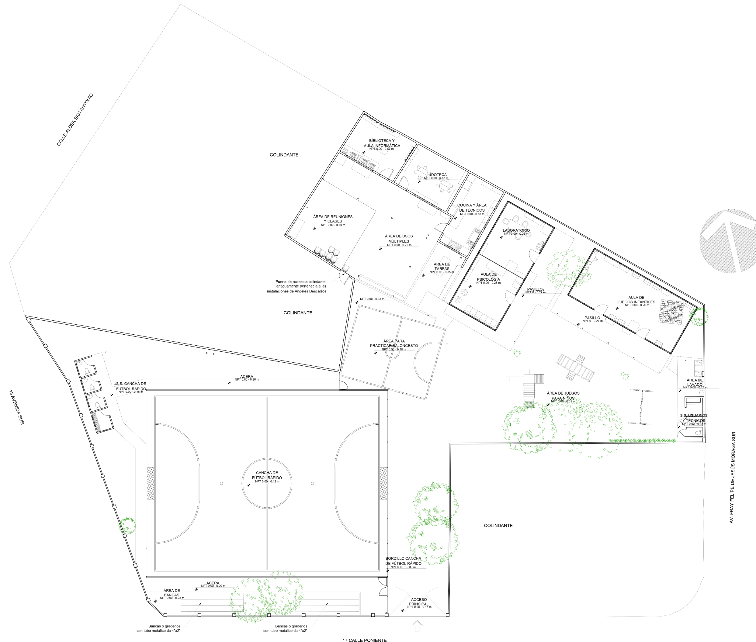
PLANTA DE DISTRIBUCIÓN ARQUITECTÓNICA ACTUAL ESC. 1:125
