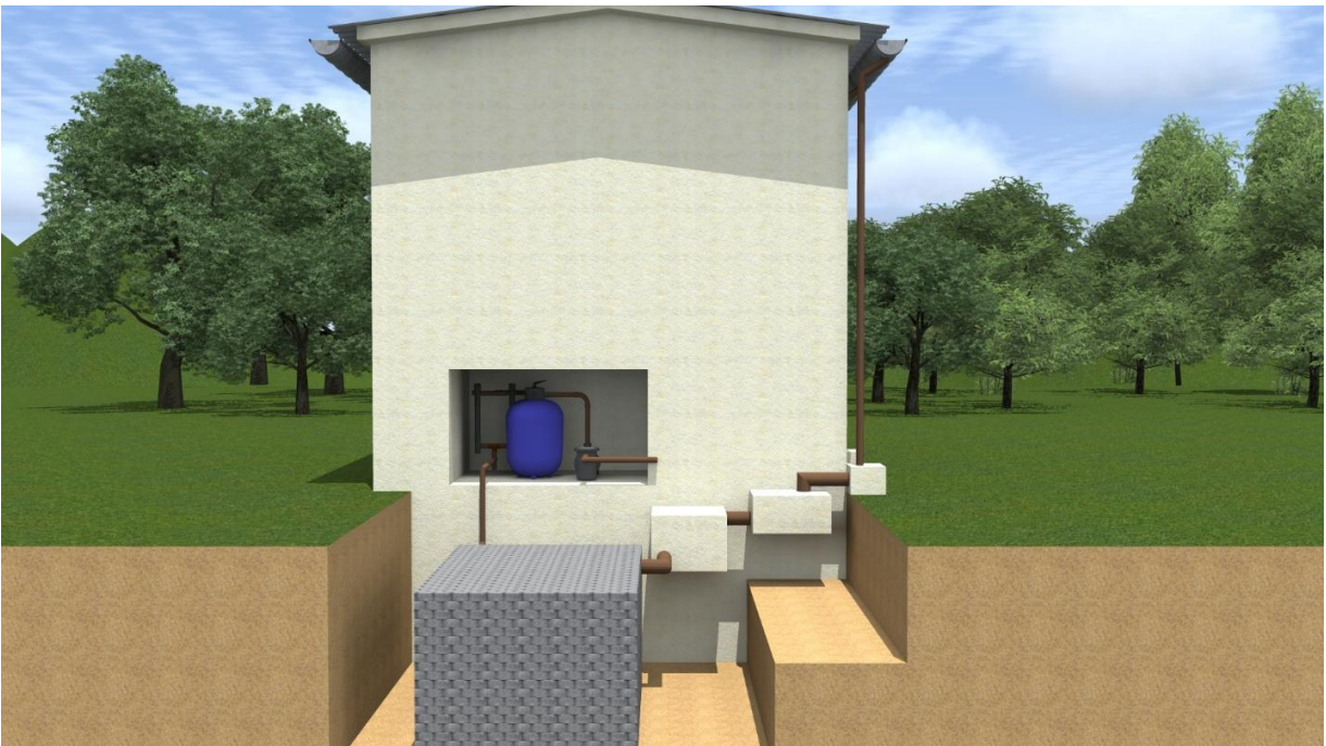
Ilustración 17 Sistema de Captación en período de invierno a través de su cubierta de techo
