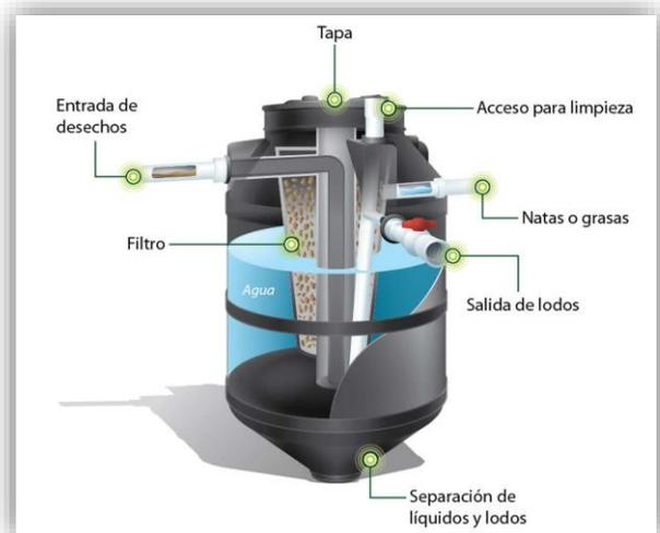
Ilustración 21: Fosa Séptica Prefabricada Componentes. Fuente: (Rotoplas, 2017)
