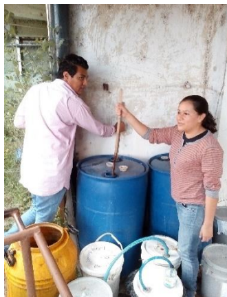
Figura A-10. Homogenización de la muestra en los barriles contenedores.
