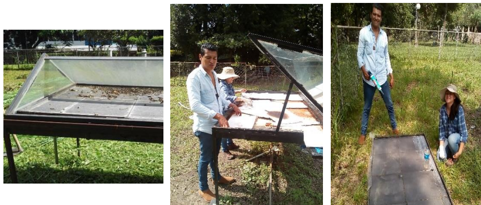
Figura A-7. Adecuación del deshidratador con cobertura de vidrio.
