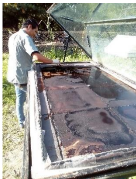
Figura A-19. Lavado de las piletas de los deshidratadores
