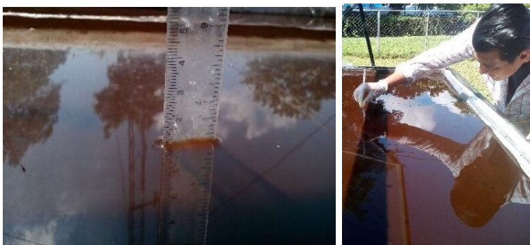
Figura A-14. Medición de la lámina evaporada.
