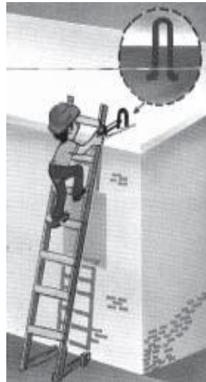
Figura 6.7: Fijación de escaleras.
