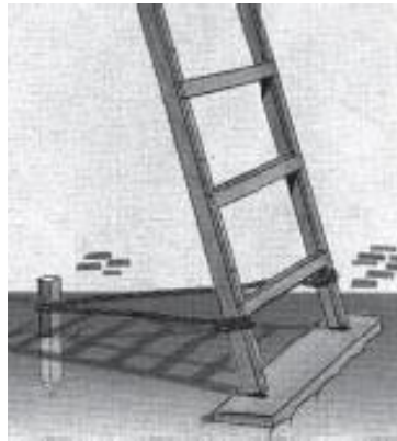
Figura 6.8: Fijación de escaleras.
