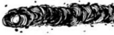
Figura 2.39: Mal aspecto en soldadura.
