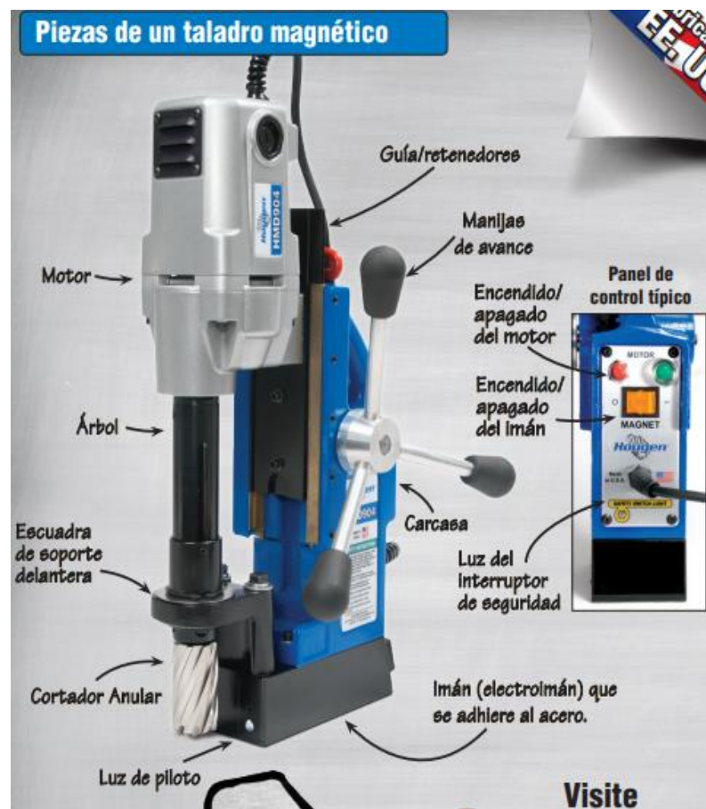
Figura 3.10: Partes de un taladro.
