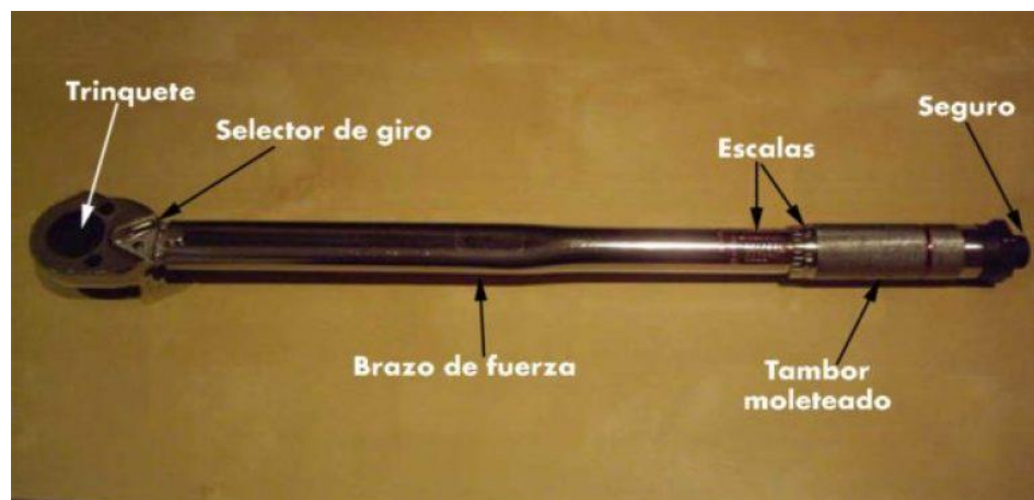
Figura 5.21: Partes de un torquímetro.
