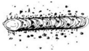
Figura 2.41: Salpicadura excesiva en soldadura.
