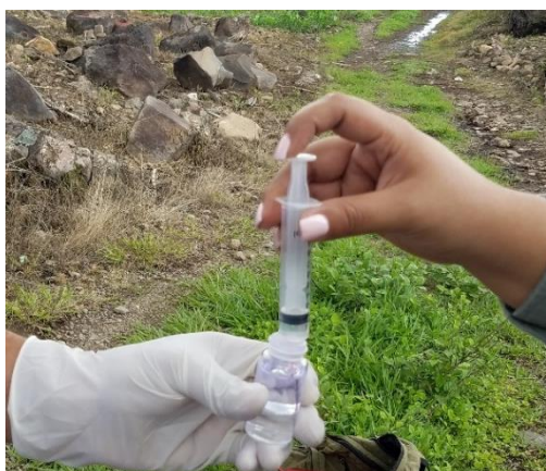
Figura 2.8: Llenado de un vial de vidrio con muestra de agua para su análisis por centelleo líquido.
