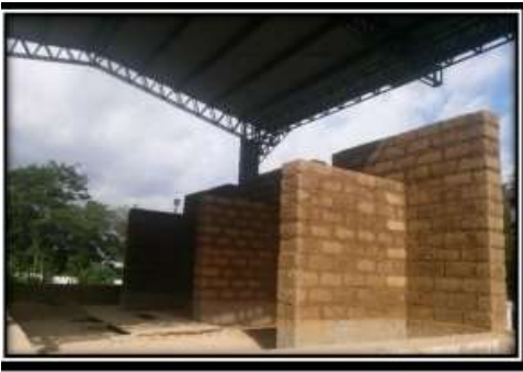
Ilustración 7 Modelos a ensayar en Mesa Inclinable
