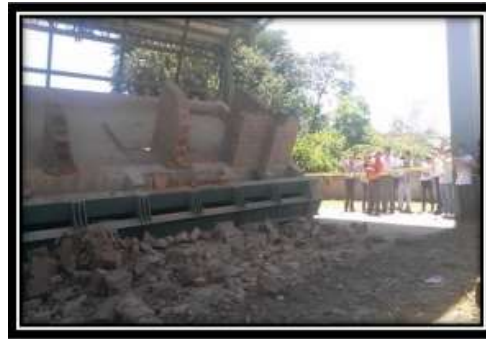
Ilustración 8 Ejecución de Ensayo Inclinable
