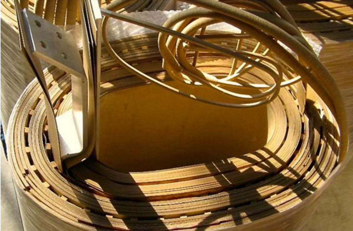
Figura 1.28 Transformador con papel Kraft como aislamiento solido
