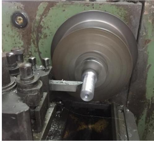
Fig. 3.17. Cilindrado de barra hexagonal.
