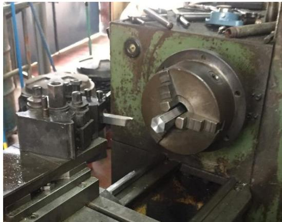
Fig. 3.16. Colocación de barra hexagonal en plato de mordazas.
