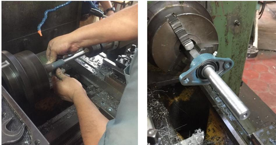
Fig. 3.18. Ajuste de eje en chumacera
