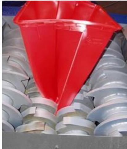
Fig. 1.10. Molino triturador de 4 ejes [16].
