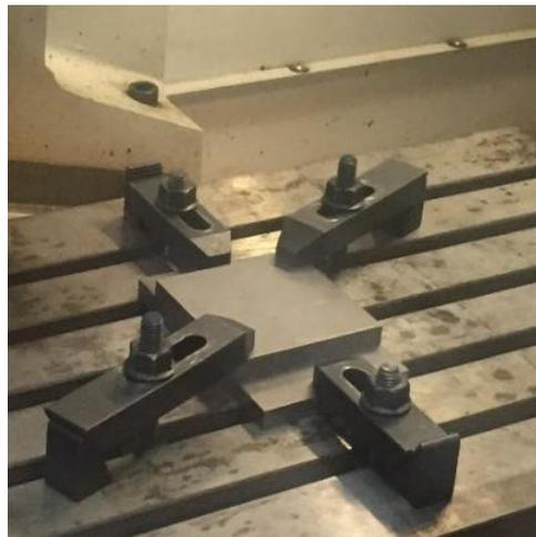
Fig. 3.4. Sujeción de la materia prima.
