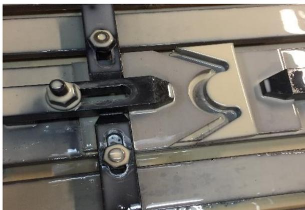
Fig. 3.15. Maquinado del separador de pared.
