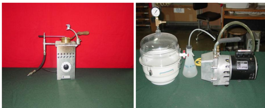
Fotografía 2.1b Equipo para Prueba de Punto de llama y gravedad teórica máxima
