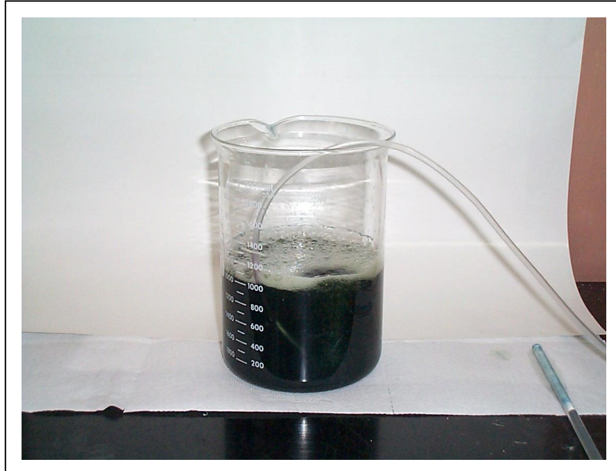
Figura 5.7 Proceso de oxigenación.
