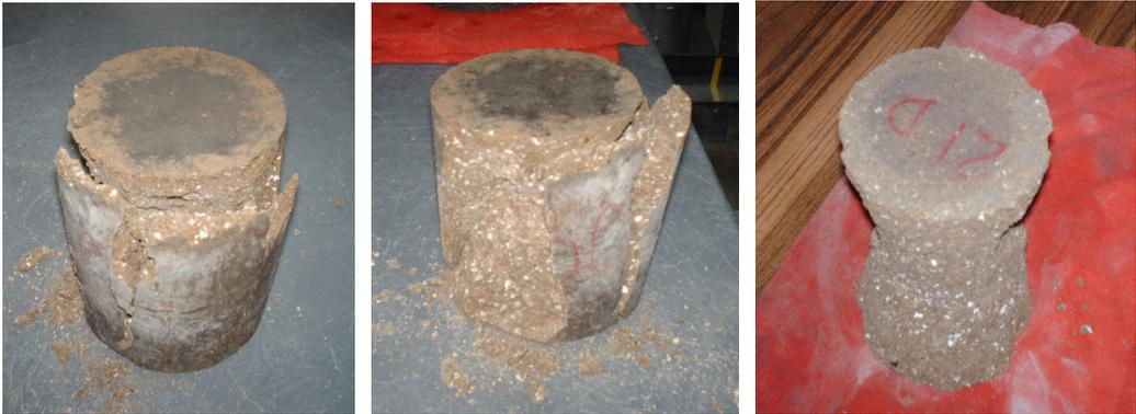
**Fig. 3. 39. Falla cónica presentada en los especímenes ensayados.**
