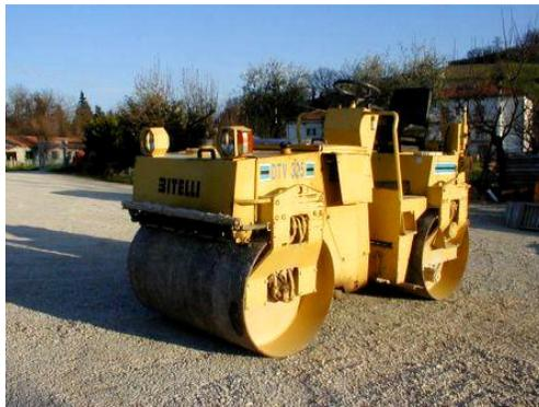
**Fig. 2.34 Compactador de rodillos tándem.**
