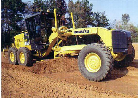
**Fig. 2.30** Extendido de material con Motoniveladora.
