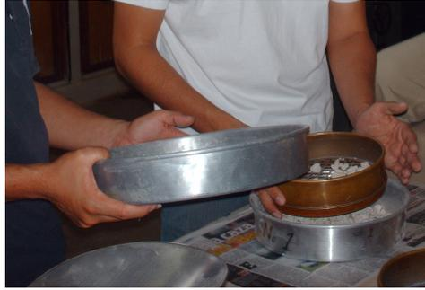
**Fig. 3. 5. Tamizado manual del suelo.**
