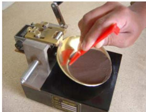
**Fig. 3. 11. Utilización de ranurador ASTM.**
