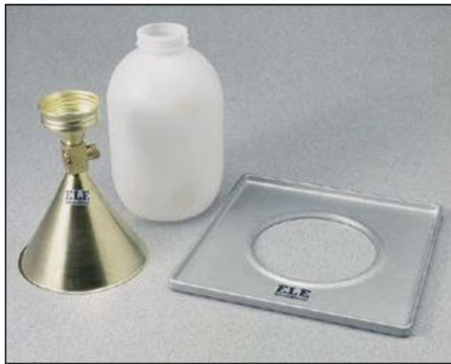
**Fig. 2.40** Equipo utilizado en el método del cono de arena.
