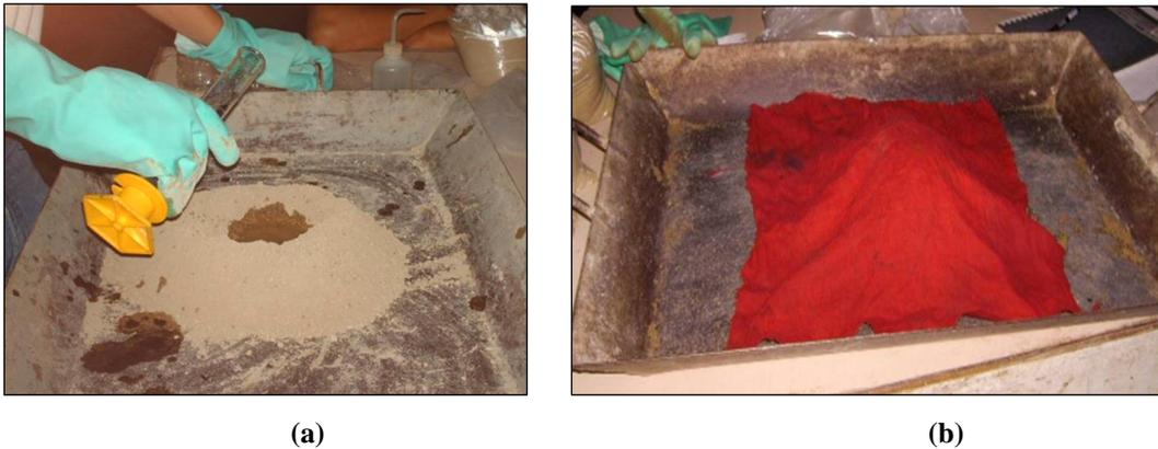
**Fig. 3. 21. (a) Adición de agua a la mezcla de suelo cemento. (b) Mezcla de suelo cemento protegida de la pérdida de humedad.**
