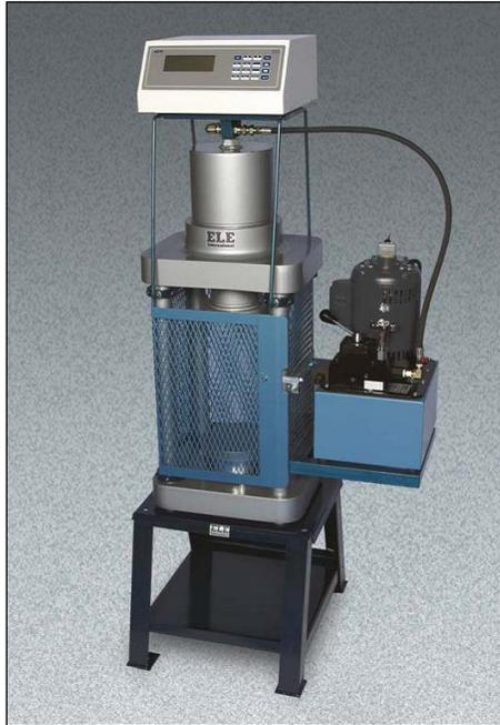
**Fig. 2.42** Maquina utilizada en el ensayo de compresión simple.
