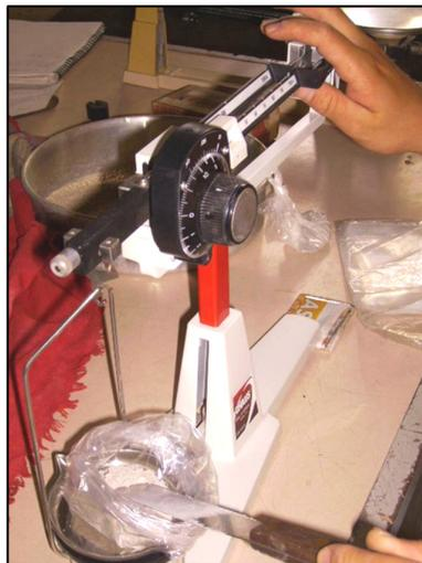
**Fig. 3. 19. Pesado de cemento en balanza de 0.01 gr. De precisión.**
