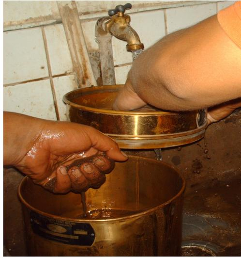
**Fig. 3. 3. Lavado del material en el ensayo de granulometría por malla N° 200.**
