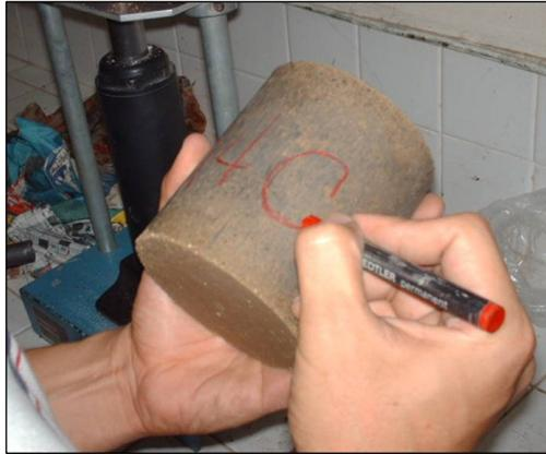
**Fig. 3. 26. Rotulado de cilindros previo al almacenamiento.**
