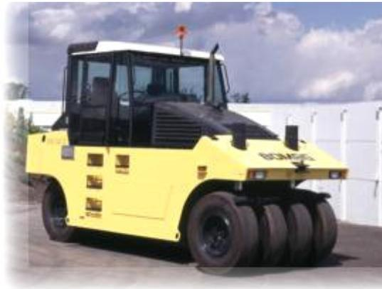
**Fig. 2.35 Compactador neumático.**
