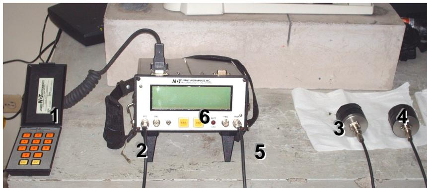
**Fig. 3. 30 Equipo utilizado en el ensayo de pulso ultrasónico.**
