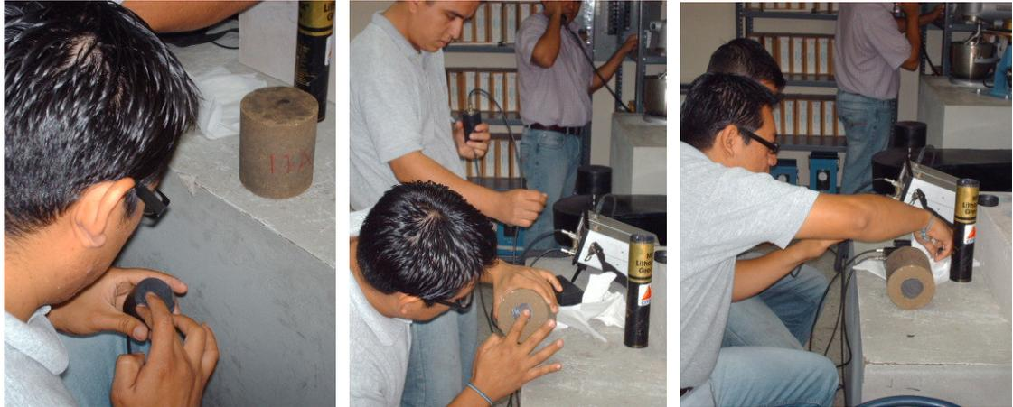
**Fig. 3. 33. Proceso de engrasado de transductores y superficies laterales del espécimen.**
