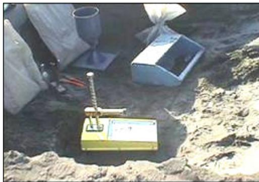
**Fig. 2.39** Equipo utilizado para control de densidad en campo.
