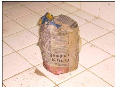
**Fig. 3. 27. Curado de especímenes utilizando papel húmedo.**
