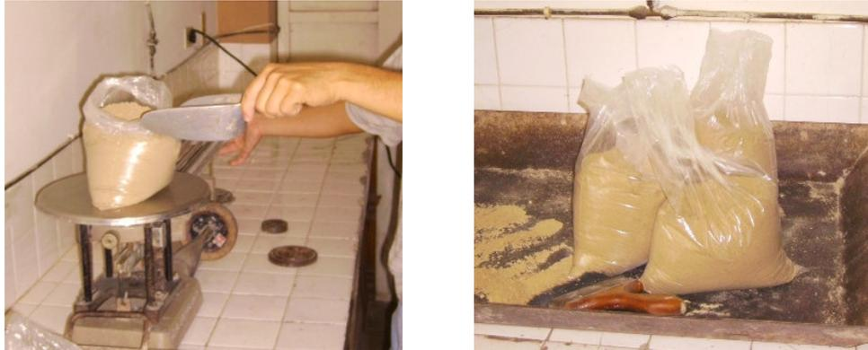
**Fig. 3. 18. Pesado y almacenamiento del suelo para la elaboración de la mezcla.**
