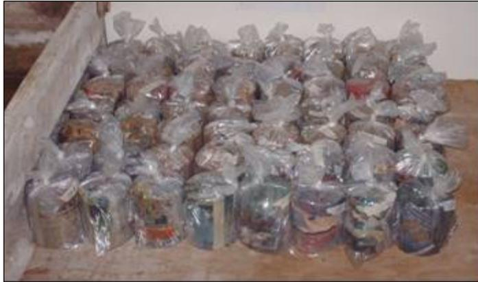
**Fig. 3. 28. Almacenamiento de especímenes en cuarto húmedo.**
