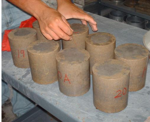
Fig. 3. 36. Especímenes saturados superficialmente secos.
