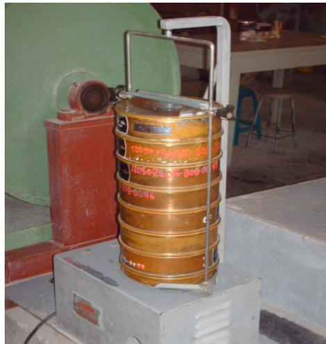
**Fig. 3. 4. Tamizado mecánico del suelo.**
