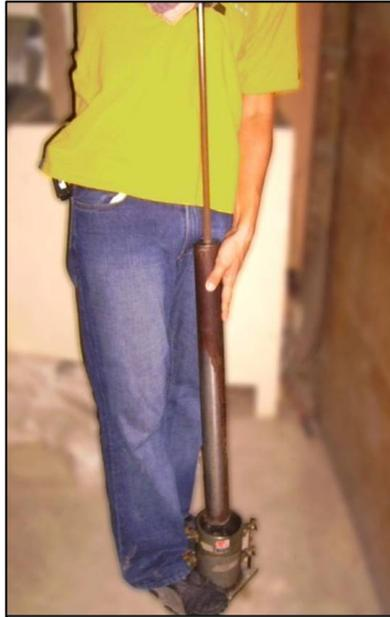
**Fig. 3. 22. Elaboración de Especímenes de suelo cemento.**
