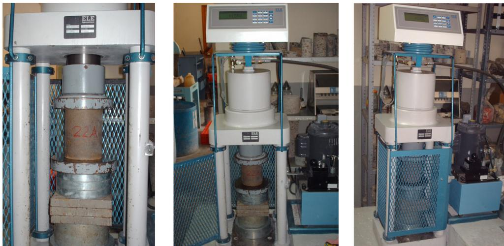
**Fig. 3.38. Ensayo de compresión en especímenes de suelo cemento.**
