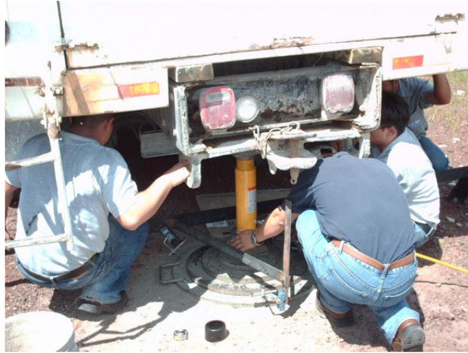
**Fig. 2.11** Equipo utilizado en la realización de prueba de placa de carga
