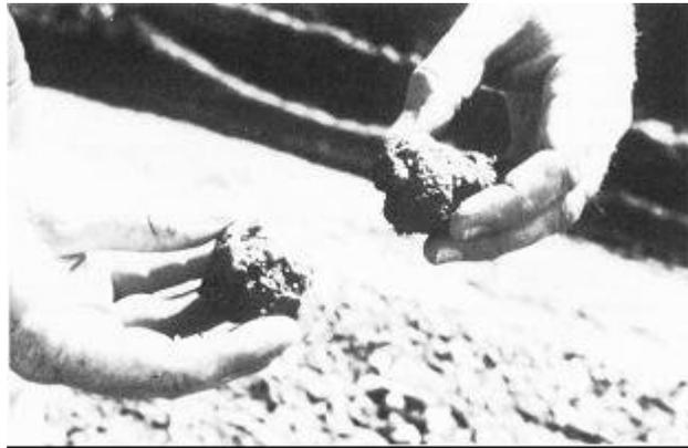
**Fig. 2.38 Verificación de la humedad previa a la compactación.**
