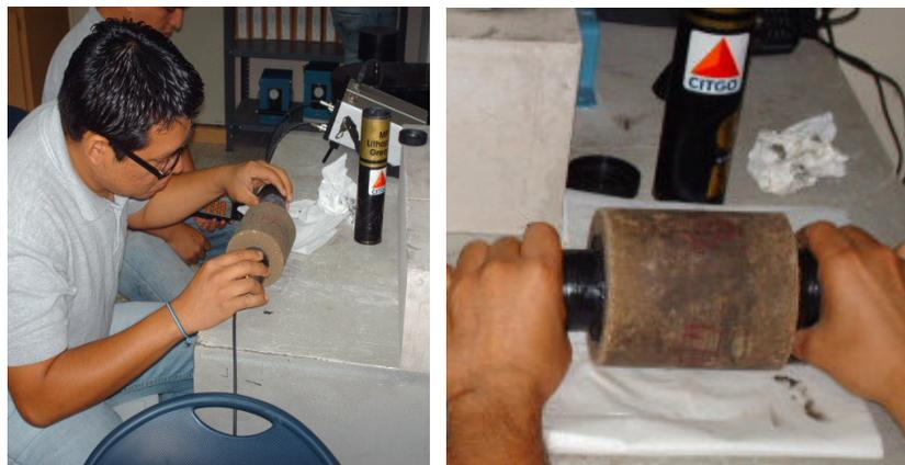
**Fig. 3. 34. Ensayo de probetas, se observa la alineación de los transductores en el espécimen.**
