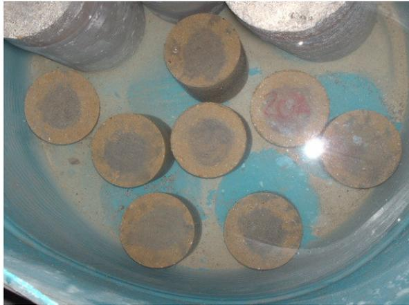
**Fig. 3. 35. Saturación de especímenes previo a el ensayo de compresión.**
