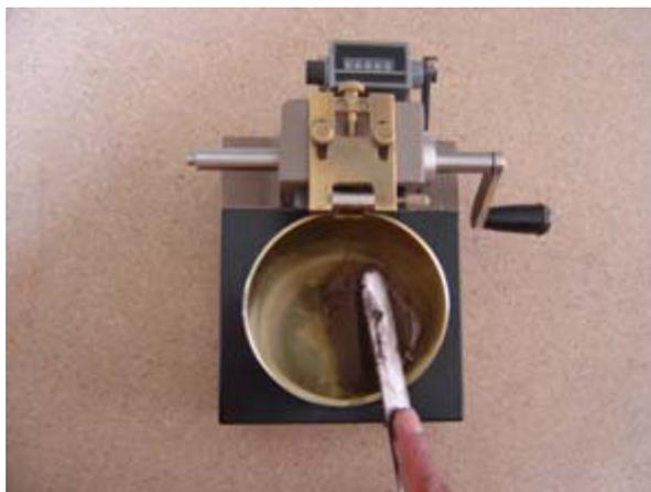
**Fig. 3. 9. Colocación de la muestra en la Copa de Casagrande.**
