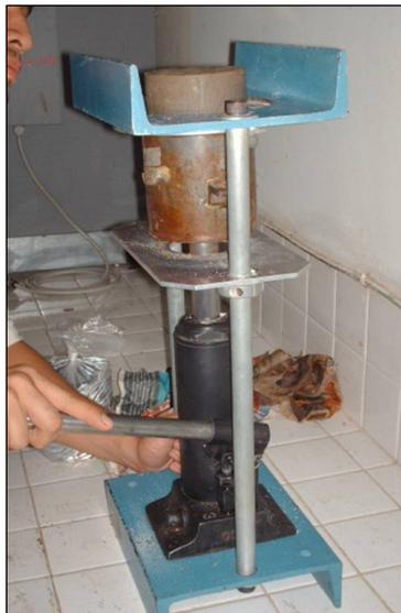
**Fig. 3. 25. Desmoldado de cilindro por medio de extractor de muestras.**
