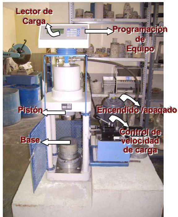
Fig. 3. 37. Maquina de ensayo a compresi3n.
