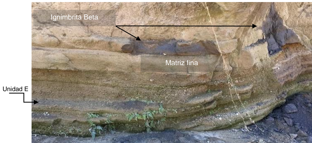
Figura No 4.16. Representación de la apariencia de la Ignimbrita Beta (en coloración café) el talud ZF-1 sección izquierda. Ubicado sobre la Quebrada del Arenal seco. Zona Franca San Bartolo Ilopango Matriz muy fina (limo), muy consolidada.
