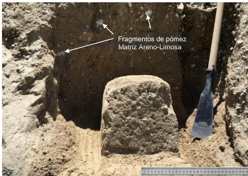
Figura No 4.6. Representación del material que conforma al Talud No2 UES del punto No 2 en la zona de La Bóveda dentro del Campus universitario de la facultad de Ingeniería y Arquitectura (regla en centímetros). El material consiste en una matriz areno-limosa con partículas de pómez con tamaño máximo de 25 mm.
