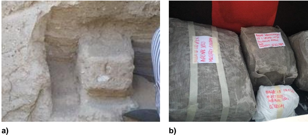
Figura No 3.4. Obtención de muestras inalteradas a) Extracción y labrado en campo de una muestra inalterada. b) Muestras inalteradas parafinadas e identificadas con la información de campo.
