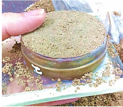
Figura No A.3. Nivelación de los extremos del espécimen, apoyándose con una placa de vidrio
