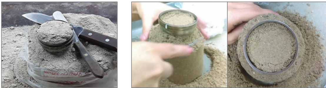
Figura No A.2. Labrado de espécimen A. en muestra inalterada, B. en cilindro compactado
