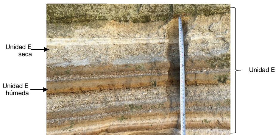
Figura No 4.14. Representación de la apariencia de la Unidad E el talud ZF-1 sección derecha. Ubicado sobre la Quebrada del Arenal seco. Zona Franca San Bartolo Ilopango (escala en metros). Intercalación de capas húmedas y secas.
