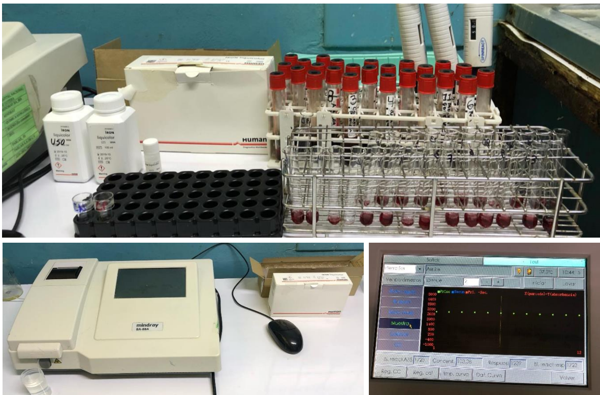
FIGURA 11: DETERMINACIÓN DE HIERRO SÉRICO POR MEDIO DEL ANALIZADOR SEMIAUTOMÁTICO DE QUÍMICA CLÍNICA BA-88
