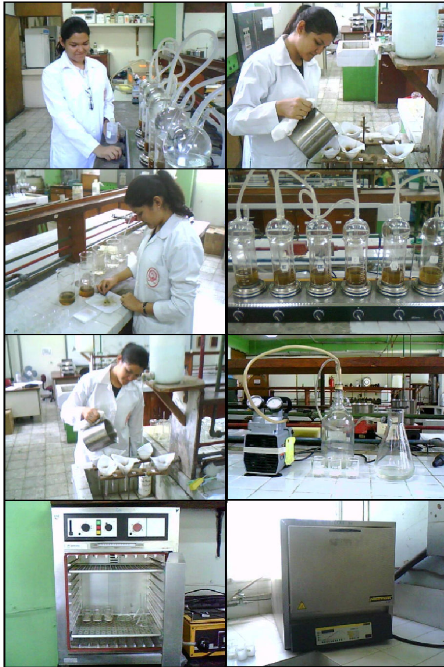
Figura N° 25 Determinación de Fibra Cruda en Muestras forrajeras, Raciones Totales Mezcladas y Fuentes de forrajes
