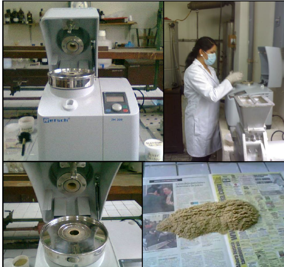
Figura N° 18 Molienda de las Muestras forrajeras, Raciones Totales Mezcladas y Fuentes de forrajes utilizando un molino con tamiz de 0.25 mm
