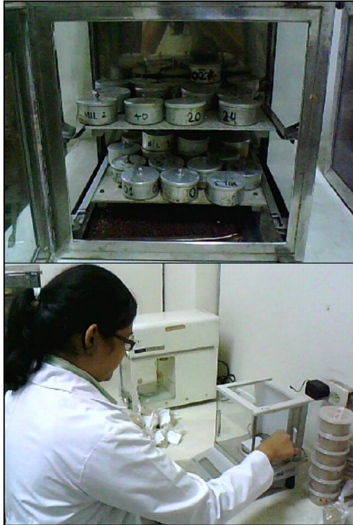
Figura N° 22 Determinación de Humedad en Muestras forrajeras, Raciones Totales Mezcladas y Fuentes de forrajes
