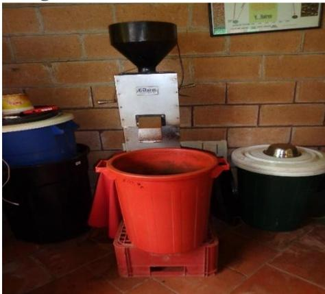
**Despulpador de Café:** se encarga de despulpar el café cereza maduro sin usar agua; clasifica el café despulpado separando granos malos y defectuosos que afectan la calidad, remueve mecánicamente el mucílago del café, lava los granos de café sin deteriorarlos y lo entrega listo para el secado. Transporta la pulpa o cascara del café por medio del sinfín opcionalmente puede mezclar la pulpa y el mucílago para utilizarlo como abono.
