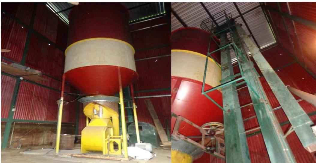
**Molino:** funciona a partir de dos discos, uno fijo y otro rotatorio. El disco rotatorio puede ajustarse de manera que esté cercano o separado del disco fijo. El café tostado pasa por gravedad en la separación que exista entre los discos y al pasar entre ellos es molido. Dependiendo de la separación que exista entre los discos así será la molienda final: mientras más juntos estén los discos, más fina será la molienda.
