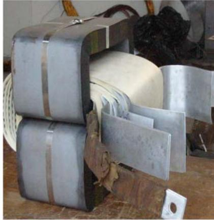
Figura 3.7 Autotransformador monofásico
