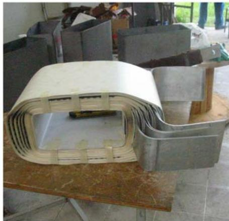
Figura 3.6 Embobinado construido
