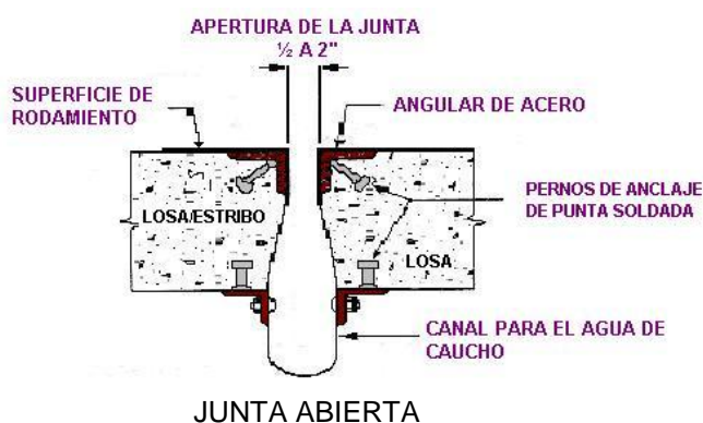
Fig. 4.67. Esquema de canales bajo juntas abiertas.
