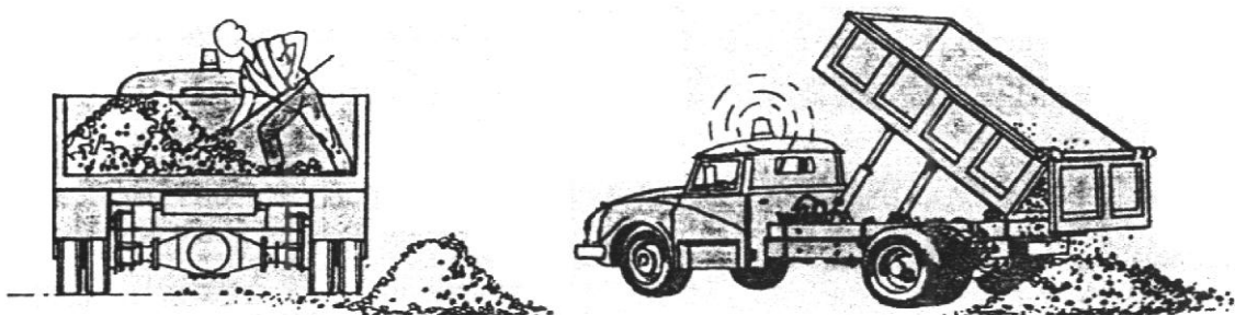
Fig. 4.52. Descarga de material en reparación de bacheo.
