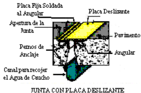
Fig. 3.26. Componentes de una Junta con Placa Deslizante.
