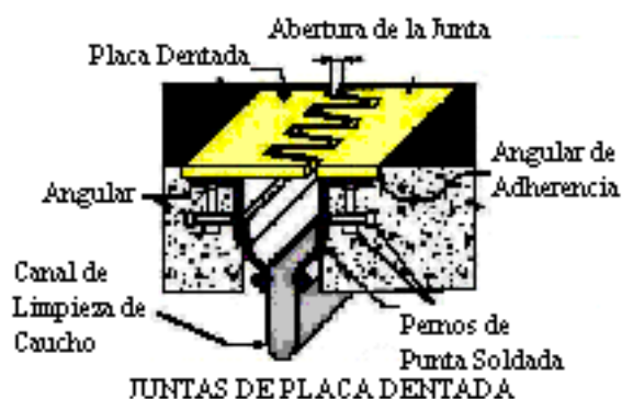
Fig. 3.24. Componentes de una Junta de Placa Dentada.
