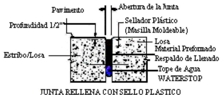
Fig. 3.20. Componentes de una Junta Rellena con Sello Plástico.
