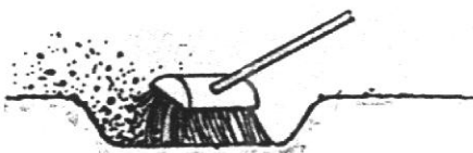
Fig. 4.53. Limpieza de baches.
