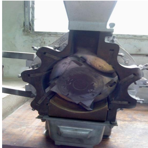
FIG. C-1. MOLINO DE CUCHILLAS PARA REDUCCION DE TAMAÑO DE PARTÍCULA DE LAS MUESTRAS
