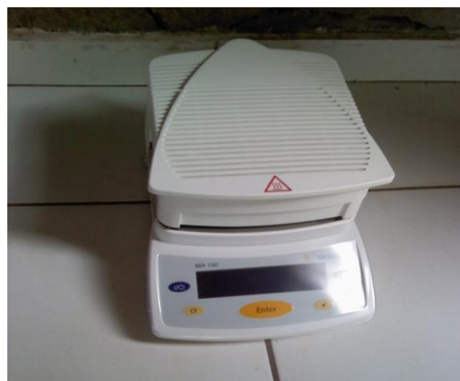
FIG. C-2. MEDIDOR DE HUMEDAD (SARTORIUS, MODEL MA150)
