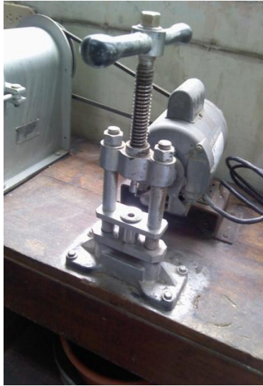
FIG.C-4. PRENSA PARA ELABORACIÓN DE LA PASTILLA.
