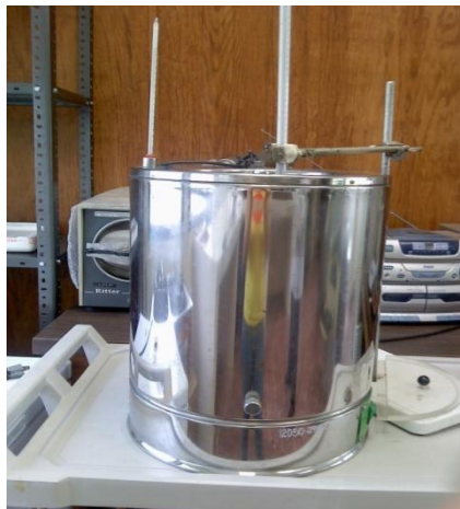
FIG. C-3. BOMBA CALORIMETRICA Parr 1314 (VISTA EXTERNA)
