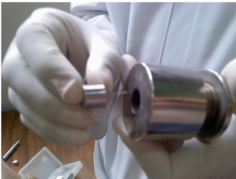
FIG. C-7. ALAMBRE FUSIBLE Y CILINDRO PARA LA ELABORACIÓN DE LA PASTILLA
