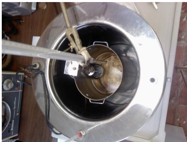
FIG. C-6. BOMBA CALORIMÉTRICA (VISTA INTERNA)
