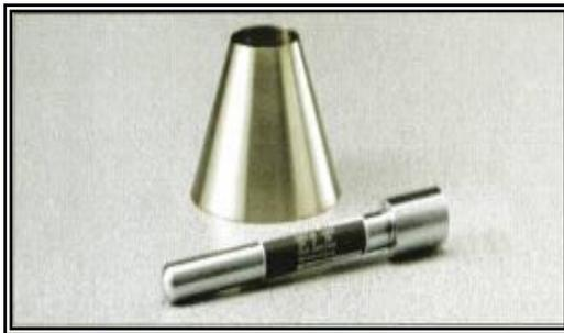
*Fig 3.14 Cono y pisón para la determinación de la absorción de arena.*
