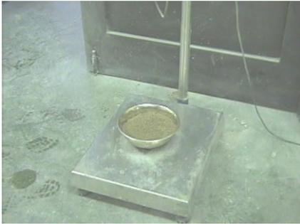
**1. Pesado de agregado fino para corrección por Humedad.**
