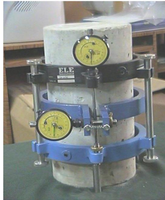
***8. Colocación de anillos para obtener los Módulos de Elasticidad y Poisson.***
