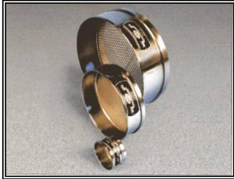
*Fig 3.5 Tamices certificados de abertura cuadrada, usados para el ensayo granulométrico.*
