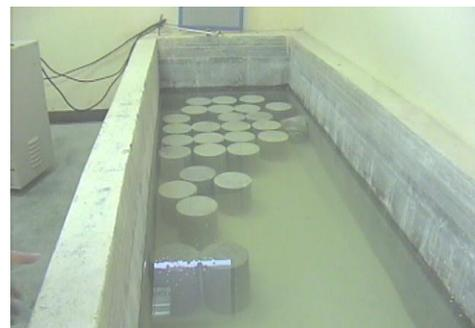
**6. Cilindros en pilas de curado con cal.**
