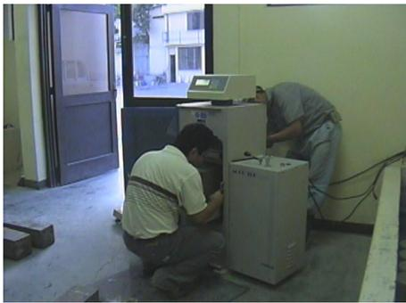
**9. Colocación de viga en máquina rompedora.**
