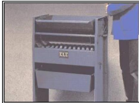
**Fig 3.1 Cuarteador mecánico para agregado grueso.**
