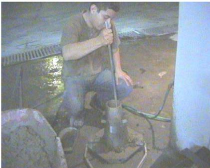
**3. Toma de Revenimiento utilizando el cono de Abrams.**
