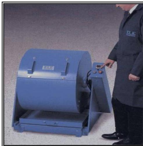
*Fig 3.7 Máquina de Abrasión Los Ángeles*
