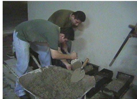
**4. Colocación de concreto en los moldes para vigas.**
