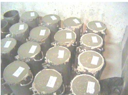
**5. Cilindros en reposo e identificación de especímenes.**
