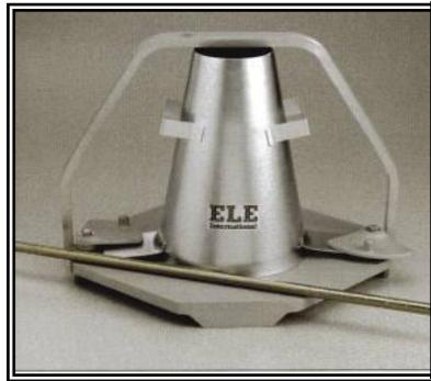
*Fig 3.16 Conjunto portátil para ensayo de asentamiento.*
