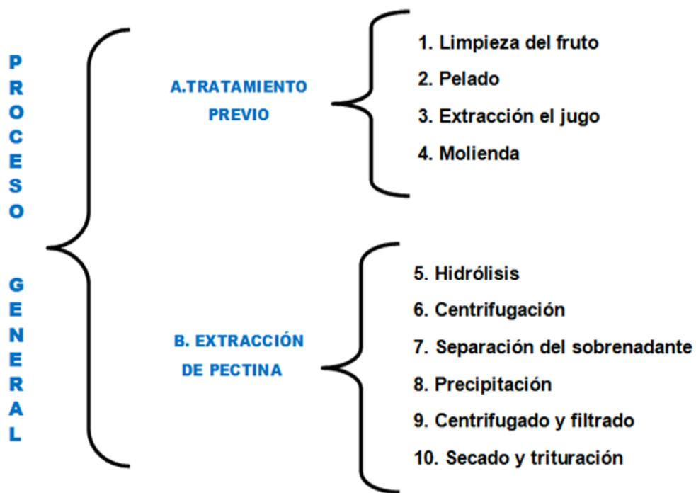
Figura N° 25. Procedimiento general para la extracción de pectina.
