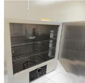
Figura N° 29. Procedimiento para la realización de la prueba de pérdida por secado.
