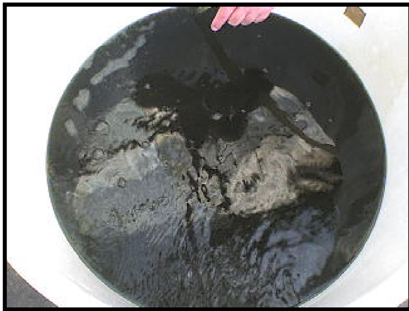
Figura 5.7. Solución extremadamente concentrada de microalgas succionada del fondo del tanque tres horas después de agregar el floculante (Preparada durante la realización de ésta investigación)
