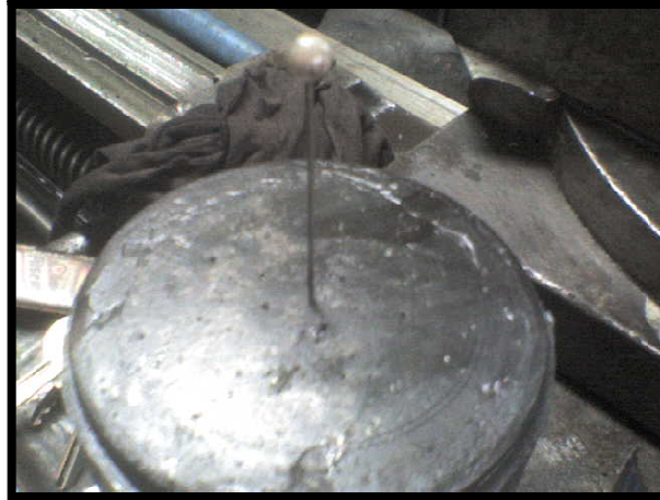
Figura 5.14. Agujeros de la camisa del pistón, cuyo diámetro es inferior al de un alfiler (Preparada durante la realización de ésta investigación)
