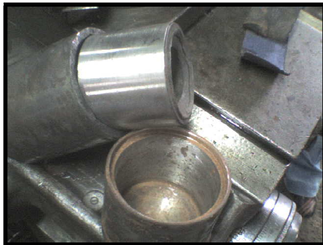
Figura 5.13. Partes de la celda de extracción de aceite de microalgas: El sistema de pistón y el recipiente para recibir el fluido rico en lípidos (Preparada durante la realización de ésta investigación)
