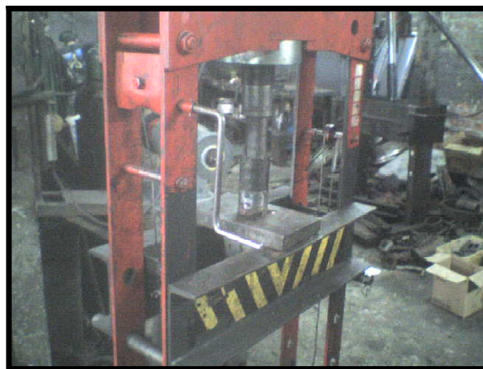
Figura 5.15. Equipo de prensado de microalgas (Preparada durante la realización de ésta investigación)
