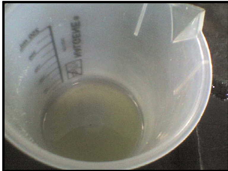
Figura 5.19. Beaker conteniendo el aceite extraído de la muestra de microalgas (Preparada durante la realización de ésta investigación)
