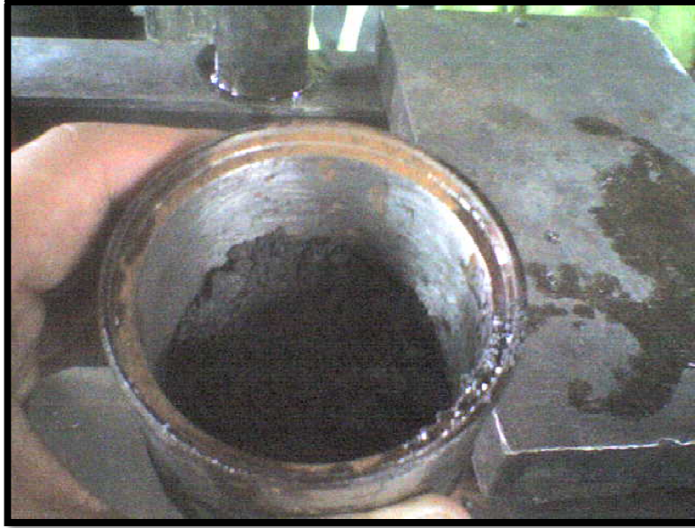
Figura 5.20. Restos de microalgas calcinadas luego de separar el pistón calentando la camisa con un soplete de acetileno (Preparada durante la realización de ésta investigación)
