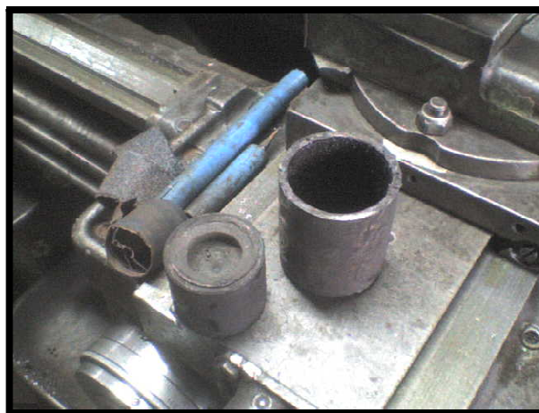
Figura 5.11. Limpieza de la celda de extracción de lípidos, ésta debe realizarse periódicamente para asegurar que no existan fugas de líquidos. (Preparada durante la realización de ésta investigación)
