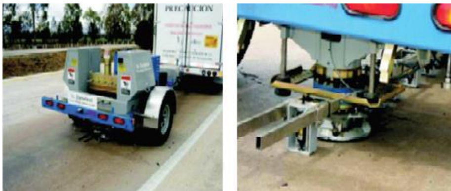
Figura 2.10: Deflectómetro de impacto.
