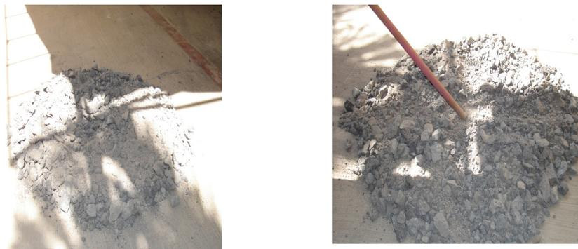
**FIG.3.25 Mezcla y Cuarteo de Agregados**
