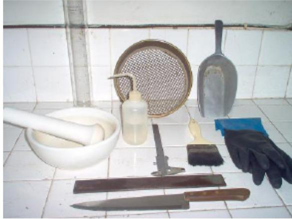
**FIG. 3.18 Equipo Utilizado Durante el Ensayo de Compactación**
