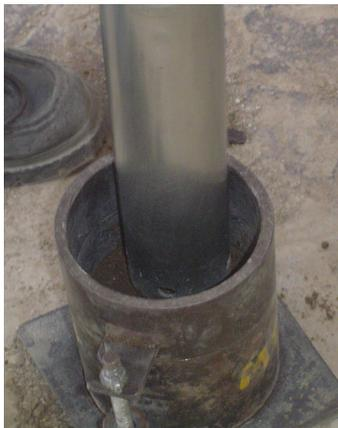
**Fig. 3.20** Compactación de la Primera Capa de Suelo Molde Proctor
