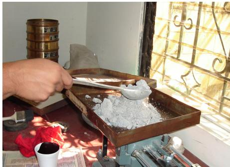
**FIG.3.37 Pesado de Agregado Pétreo**
