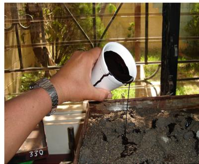
**FIG.3.30 Colocación del Porcentaje de Emulsión Asfáltica al Suelo y Agregado Pétreo**
