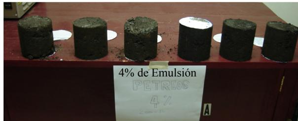
**FIG.3. 56** Probetas Grava-Emulsión con 4% de emulsión asfáltica
