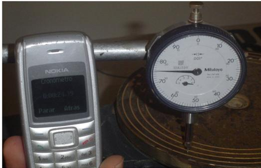
**FIG.3.61 Calibración de la Velocidad de Aplicación de la Carga**
