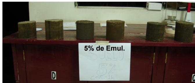
**FIG.3.49 Probetas Suelo-Emulsión con 5% de emulsión asfáltica**
