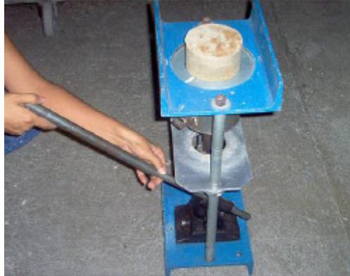
**FIG. 3.22 Extracción de la Muestra Utilizando Gato Hidráulico**
