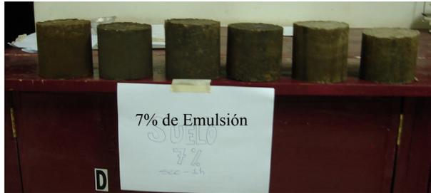
**FIG.3. 50 Probetas Suelo-Emulsión con 7% de emulsión asfáltica**
