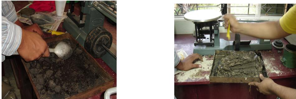
**FIG.3.41 Mezcla homogénea del suelo y agregado**
