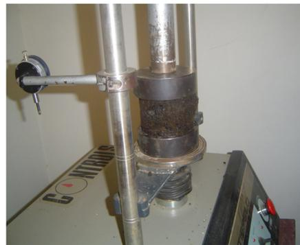
**FIG.3.64 Ensayo de Compresión Simple Axial sin Confinar (Resistencia Húmeda)**
