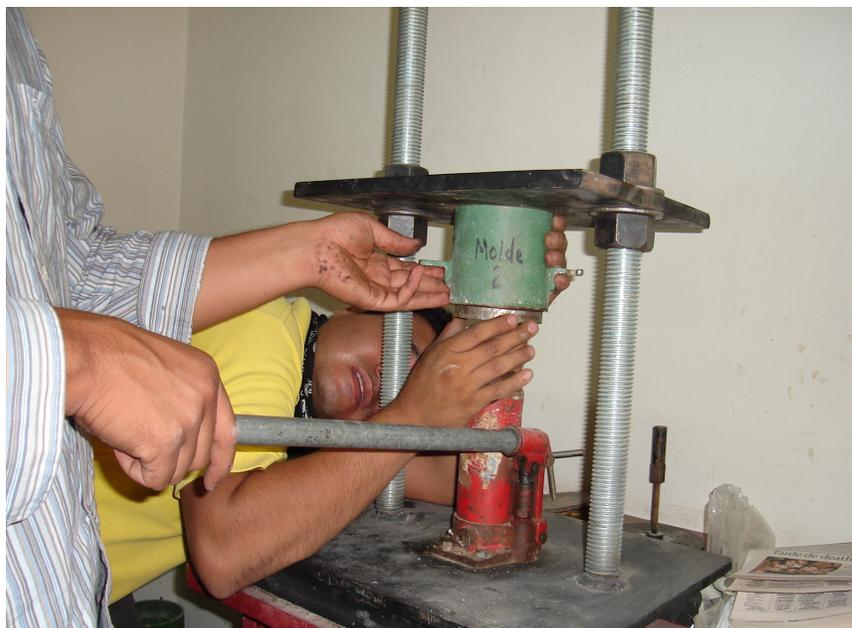
**FIG.3.47** Dispositivo de Extracción de Espécimen
