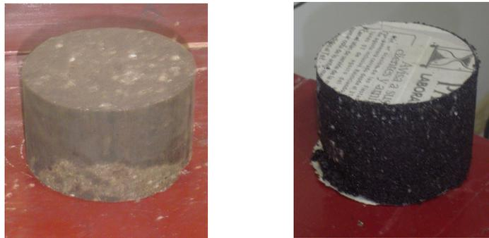
**FIG.3.32 Probeta Patrón de Suelo y Agregado Pétreo**
