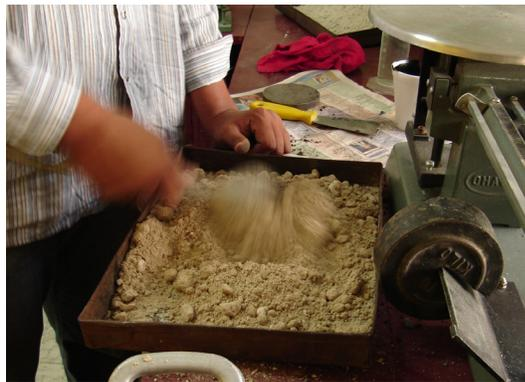
**FIG.3.35 Proceso de Disgregación de Grumos en el Suelo**
