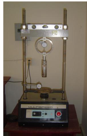
**FIG.3. 62 Equipo de Compresión**
