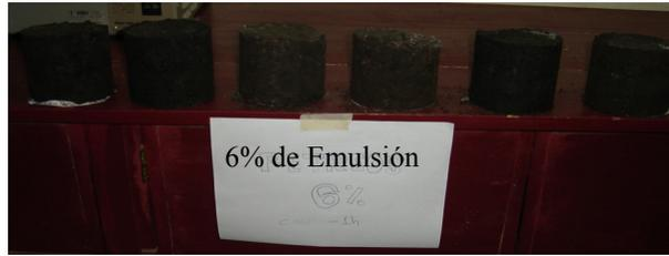
**FIG.3.58** Probetas Grava-Emulsión con 6% de emulsión asfáltica
