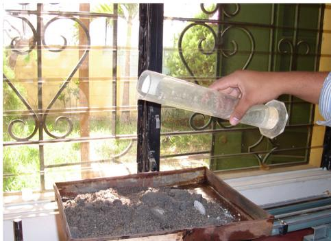
**FIG.3.38 Adición de Agua para Alcanzar la Humedad de Preenvuelta**
