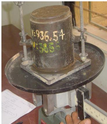
**FIG. 3.21 Determinación de la Masa del Molde más el Suelo Húmedo Compactado**
