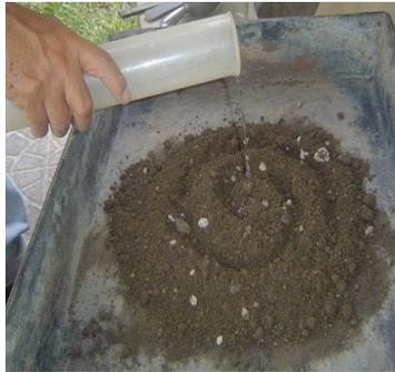
**FIG. 3.19 Humedecimiento de la Muestra para Obtener la Humedad Requerida para el Ensayo Proctor**
