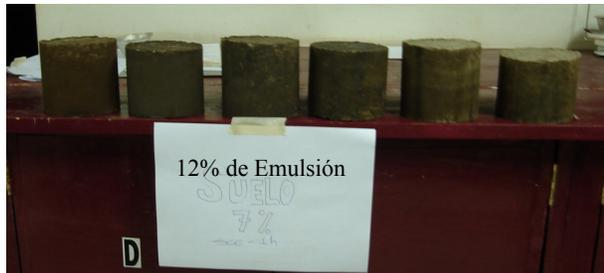
**FIG.3. 52 Probetas Suelo-Emulsión con 12% de emulsión asfáltica**
