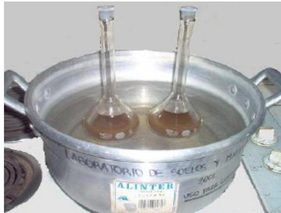
**FIG. 3.16 Desairado de la Lechada por el Método de Ebullición**
