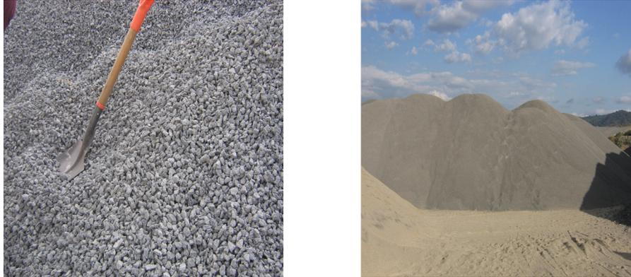
**FIG. 3.4 Toma de Muestra de Agregado Pétreo**
