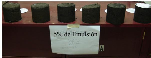
**FIG.3.57** Probetas Grava-Emulsión con 5% de emulsión asfáltica
