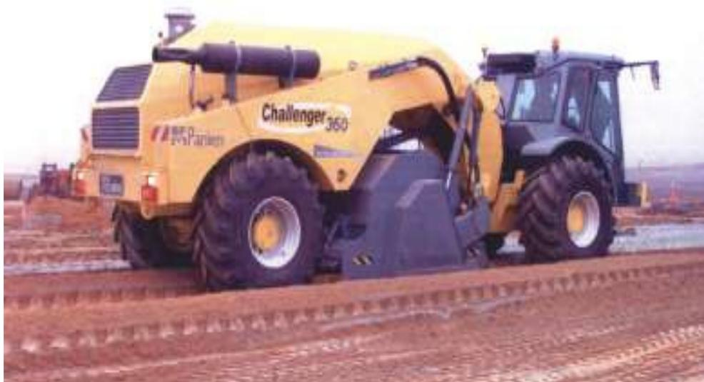
**FIG. 2.35** Equipo de mezclado y Homogenizado
