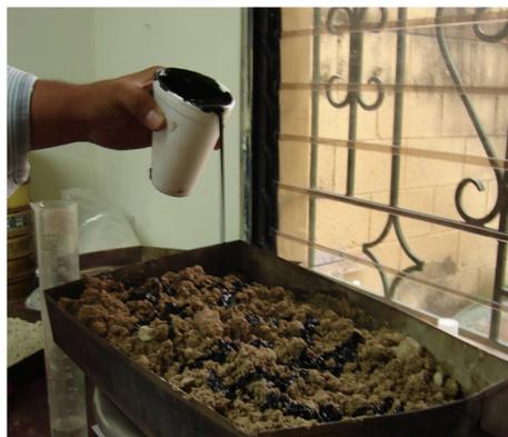
**FIG.3.36 Colocación de Emulsión Asfáltica**
