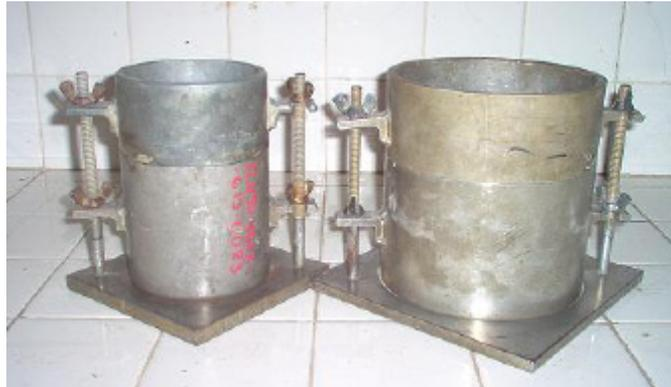
FIG. 3.17 Moldes de Compactación de 4" y 6" de Diámetro
