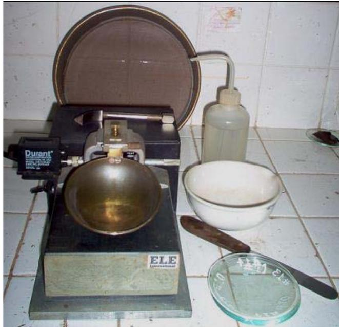
FIG. 3.10 Equipo Empleado en el Ensayo de los límites de Consistencia.
