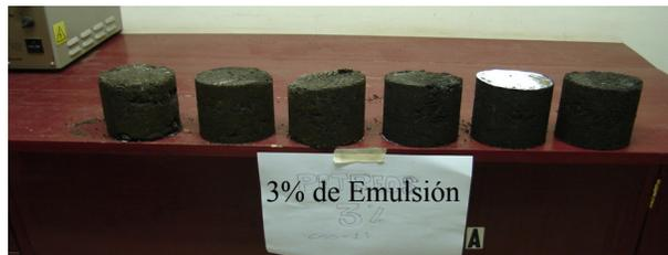
**FIG.3. 55** Probetas Grava-Emulsión con 3% de emulsión asfáltica
