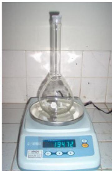
**FIG. 3.13 Determinación de la Masa del Frasco Volumétrico**
