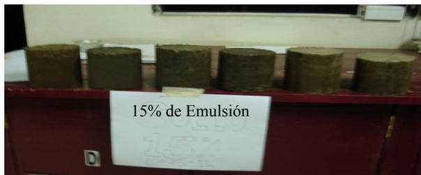
**FIG.3.53 Probetas Suelo-Emulsión con 15% de emulsión asfáltica**
