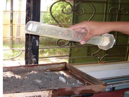
**FIG.3.28 Adición de Agua para Alcanzar Humedad de Preenvuelta**
