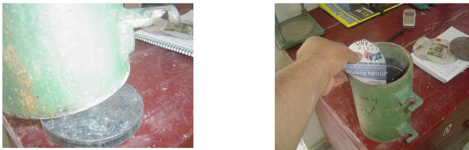
**FIG.3.42 Colocación de Soporte y Papel Filtro para Suelo y Agregado Pétreo**
