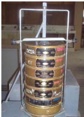
**FIG. 3.7 Ensamble y Tamizado de la Muestra Utilizando un Agitador Mecánico.**
