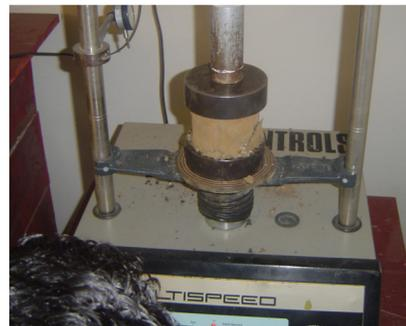
**FIG.3.63 Ensayo de Compresión Simple Axial sin Confinar (Resistencia Seca)**
