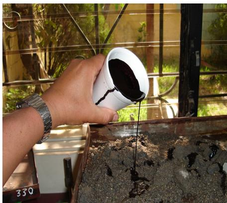
**FIG.3.40 Colocación de la Emulsión Asfáltica**
