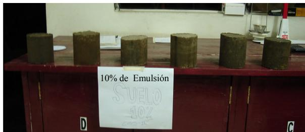
**FIG.3.51 Probetas Suelo-Emulsión con 10% de emulsión asfáltica**
