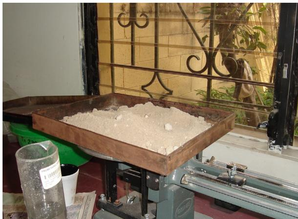
**FIG.3.33 Peso de la Muestra de Suelo**
