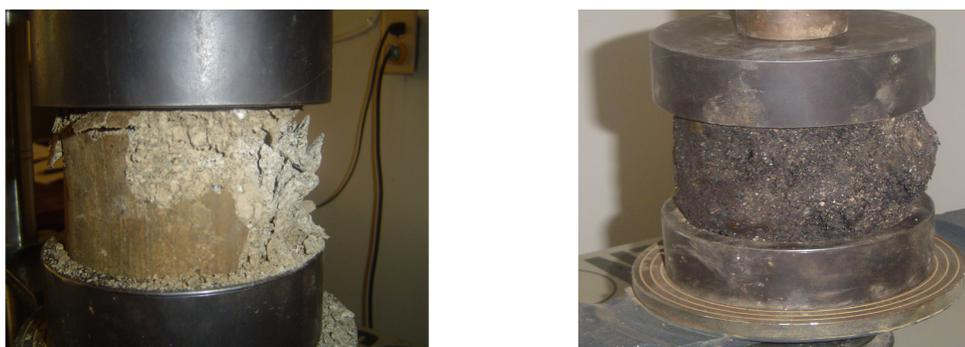
**FIG.3.65 Falla de Especímenes sometidos a carga axial**
