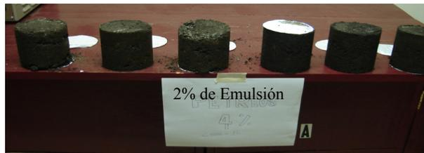
**FIG.3.54** Probetas Grava-Emulsión con 2% de emulsión asfáltica
