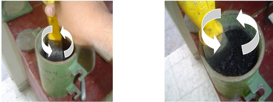
**FIG.3.43 Distribución del Material dentro del Molde**
