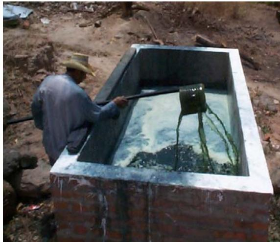
**Figura 1.3** Etapa de Oxigenación del Proceso de Extracción del Colorante Natural Añil
