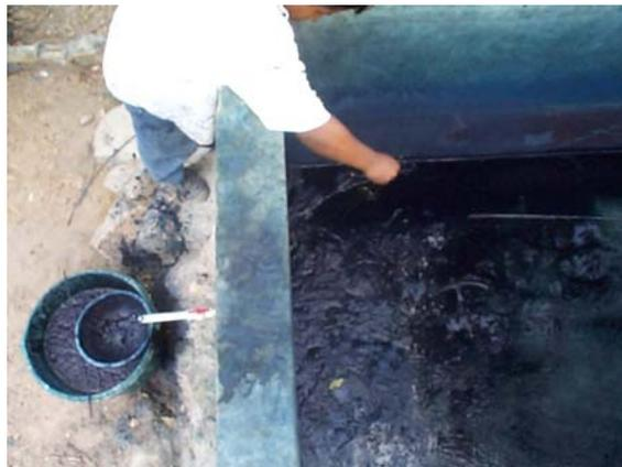
**Figura 1.4** Etapa de Descargado del Proceso de Extracción del Colorante Natural Añil
