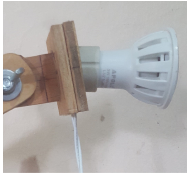
Figura 4.129: Introducir pieza O en la ranura R1. Fuente: Elaboración propia.
