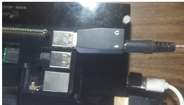
Figura 4.144: Conectar cable de audio 3.5mm. Fuente: Elaboración propia.
