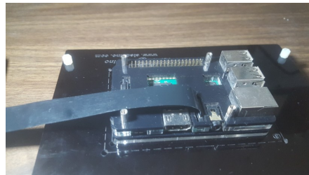
Figura 4.139: Fijar Raspberry PI. Fuente: Elaboración propia.
