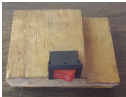
Figura 4.101: Fijar Switch en J. Fuente: Elaboración propia.
