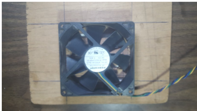
Figura 4.148: Pegar ventilador. Fuente: Elaboración propia.
