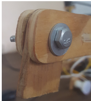
Figura 4.121: Colocar arandela entre N3 y O1. Fuente: Elaboración propia.
