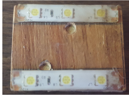
Figura 4.99: Cortar cinta LED. Fuente: Elaboración propia.
