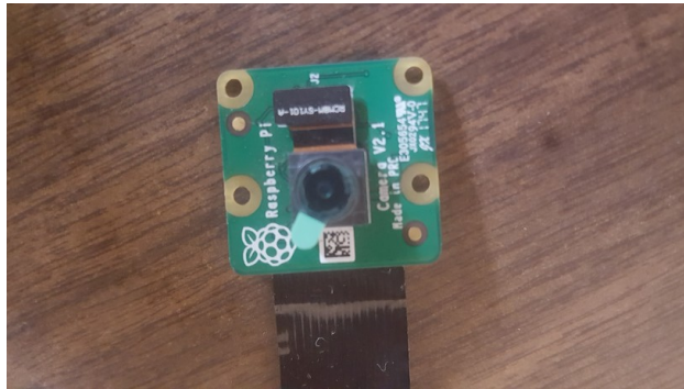
Figura 4.153: Conectar cámara al cable conector. Fuente: Elaboración propia.
