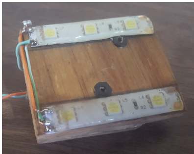
Figura 4.105: Unir circuito cintas LED con switch. Fuente: Elaboración propia.
