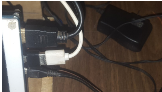
Figura 4.155: Conectar cable de corriente a la Raspberry Pi. Fuente: Elaboración propia.
