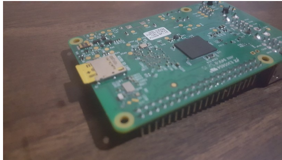
Figura 4.135: Colocar memoria MicroSD en la Raspberry PI. Fuente: Elaboración propia.
