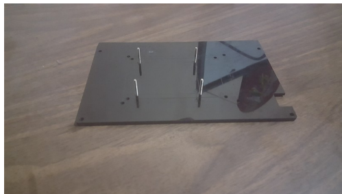
Figura 4.133: Colocar tornillos de la Raspberry PI. Fuente: Elaboración propia.
