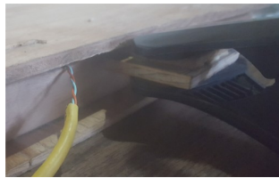
Figura 4.112: Sujetar pinza en las piezas I. Fuente: Elaboración propia.
