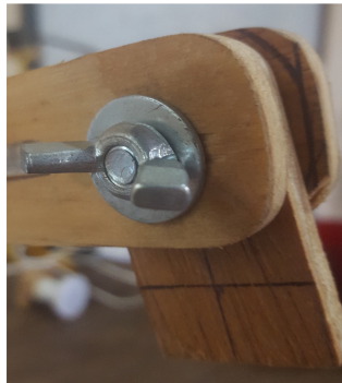
Figura 4.122: Colocar arandela en el perno entre N y O. Fuente: Elaboración propia.
