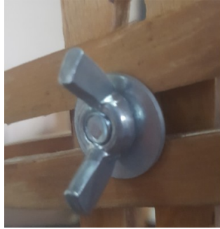
Figura 4.120: Colocar arandela entre N y L. Fuente: Elaboración propia.
