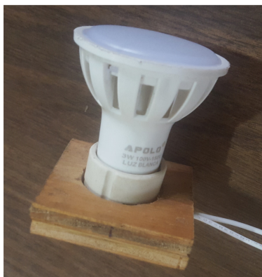
Figura 4.128: Colocar foco en su base. Fuente: Elaboración propia.
