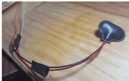
Figura 4.108: Unir extremo del cable con conector de batería de 9V. Fuente: Elaboración propia.
