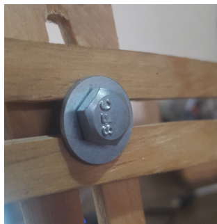
Figura 4.119: Colocar arandela en L1. Fuente: Elaboración propia.
