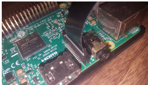
Figura 4.136: Conexión cable de cámara. Fuente: Elaboración propia.
