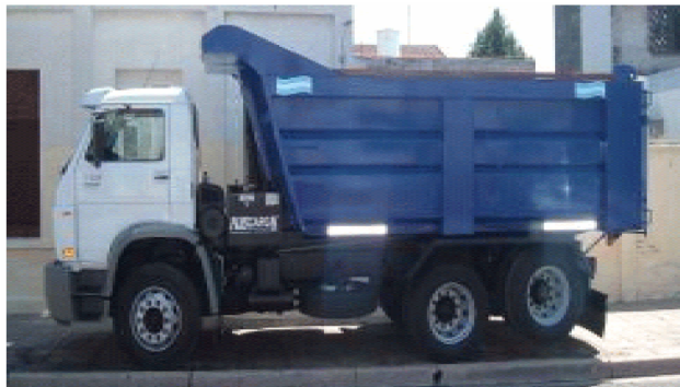
FIG. 4.21. Camión de volteo para transporte de la mezcla estabilizada.
