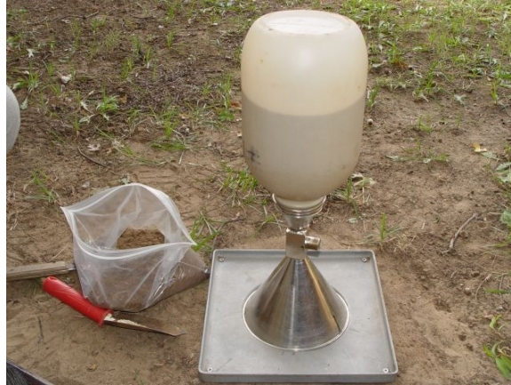
FIG. 2.25. Equipo empleado en la determinación del peso específico seco del suelo por el método del cono de arena.
