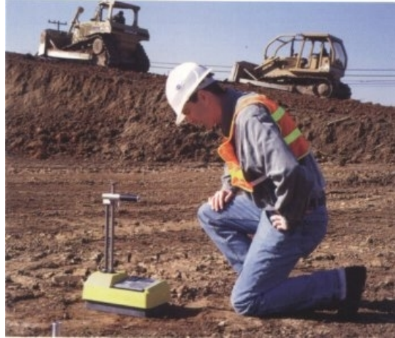
FIG. 2.27 Equipo empleado en la determinación del peso específico seco del suelo por el método nuclear.
