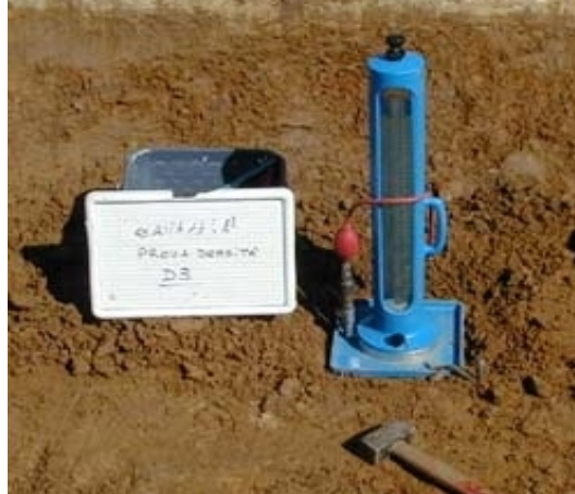
FIG. 2.26 Equipo empleado en la determinación del peso específico seco del suelo por el método del globo de hule.
