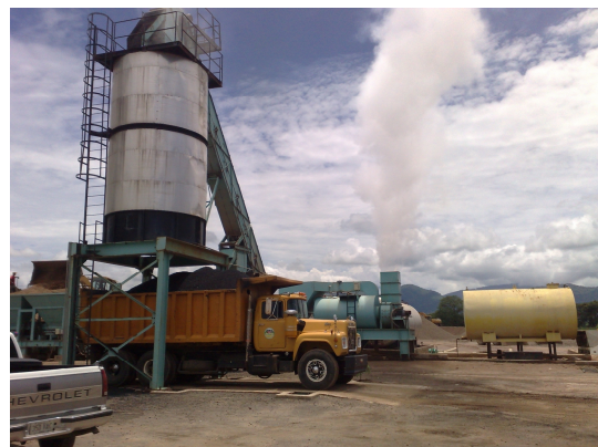
FIG. 4.20. Planta mezcladora de tipo discontinuo para suelo-emulsión.
