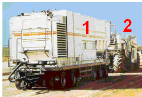
FIG. 4.8. Equipo para fabricación de lechada acoplado a escarificador-dosificador, empleado en la operación de dosificación del cemento por vía húmeda en campo.
