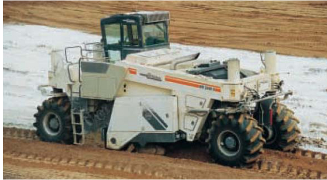
FIG. 4.14. Pulvimezclador Wirtgen para mezclado de la cal con el suelo de base en un tramo de carretera.
