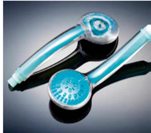
Imagen 5 Prototipos fabricados con estereolitografía Fuente: Materialise, 2015
