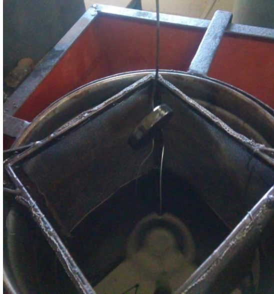
Fig. 2.4. Disco con tratamiento térmico de temple.
