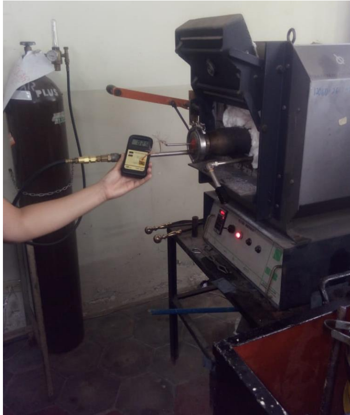
Fig. 2.3. Horno y cámara de gas inerte que se utilizó para realizar el tratamiento térmico de los discos.
