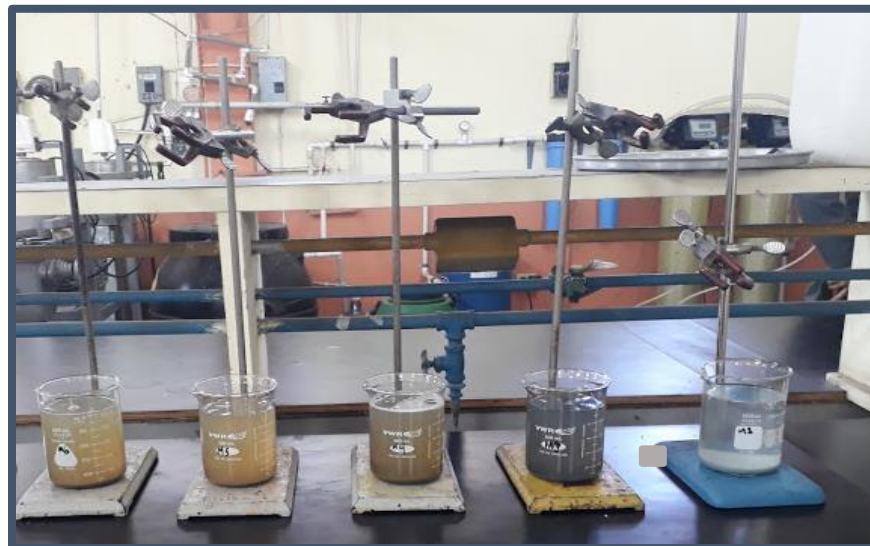
Figura 6-2. Prueba de Jarras para determinar SST
