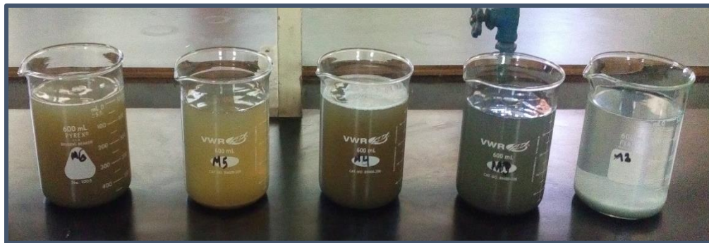
Figura 6-5 Aguas Residuales Crudas con Coagulantes.
