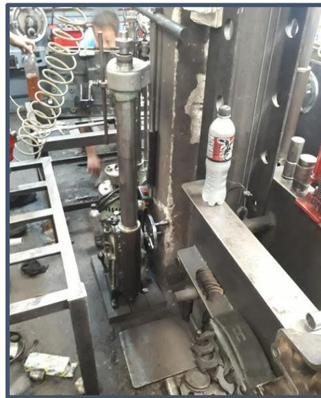
Figura 1-4 Torno usado para camisas
