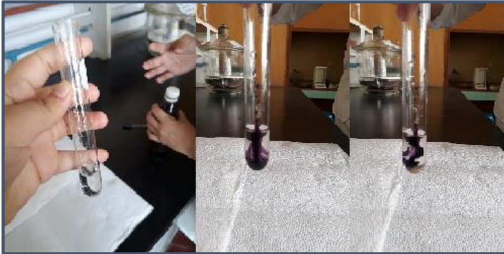
Figura 5-8. Prueba de Tricloruro de Hierro en Fenoles
