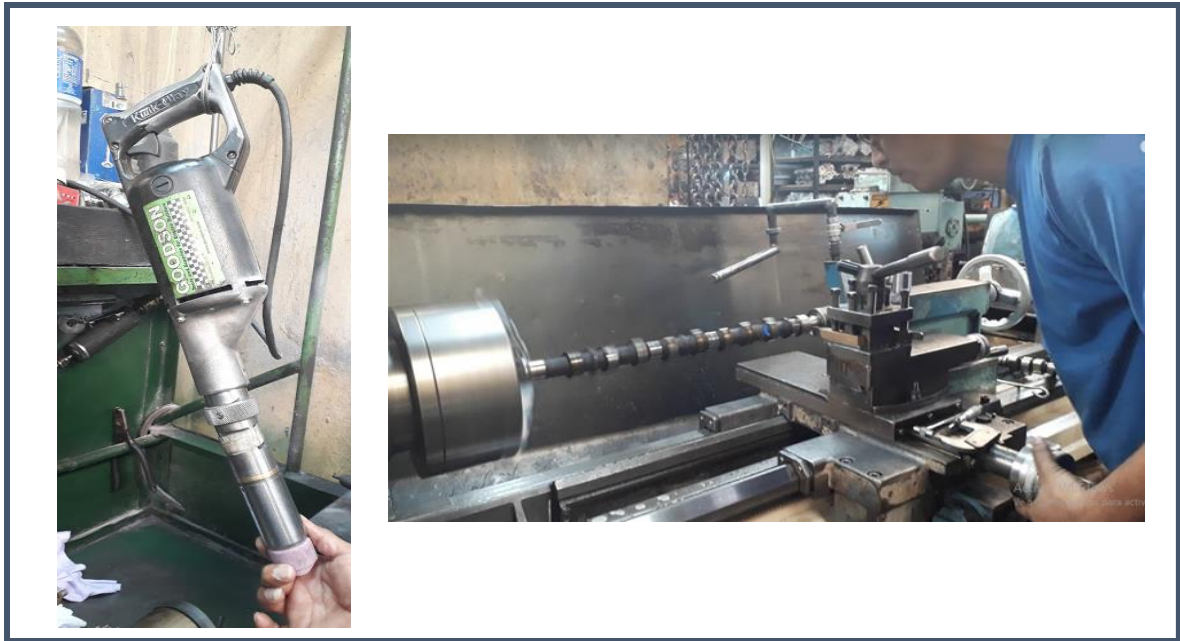
Figura 1-3 Rectificador de válvulas de asiento y torno usado para válvulas de asiento.
