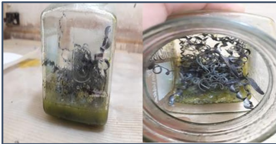
Figura 4-6 Inicio de Reacción de Acero VCN 150 con HCl
