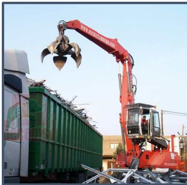
Figura. 1-2. Grúa con pulpo e imán (Recemsa, 2017)
