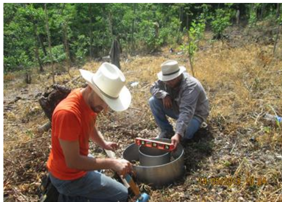
Figura 14. Toma de datos en la prueba de infiltración.
