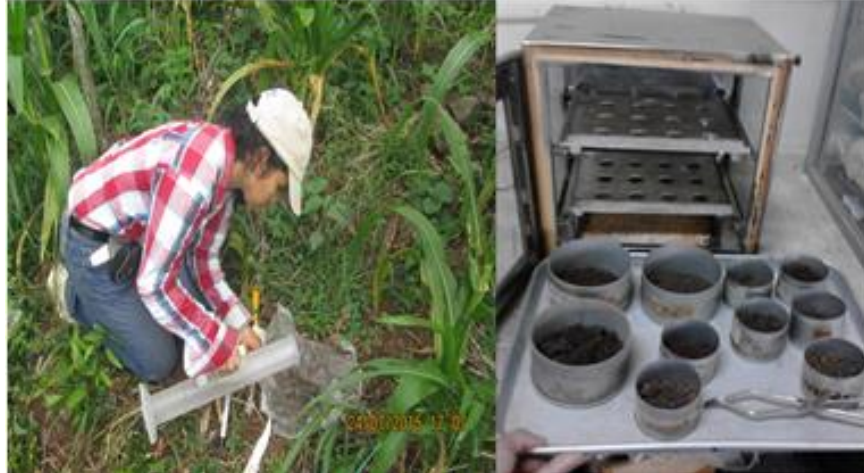
Figura 12. Toma de muestras de suelo para análisis de densidad aparente.
