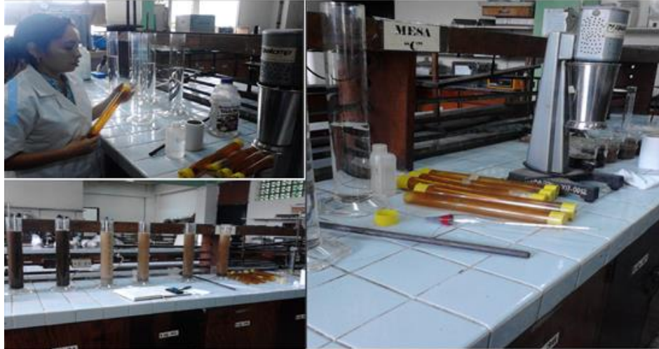
Figura 11. Análisis de granulometría del suelo en laboratorio.
