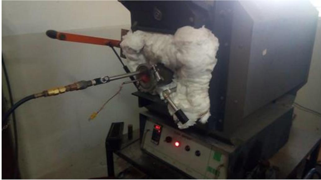
Fig. 2.4 Cámara de gas inerte utilizada durante el tratamiento térmico de los discos.
