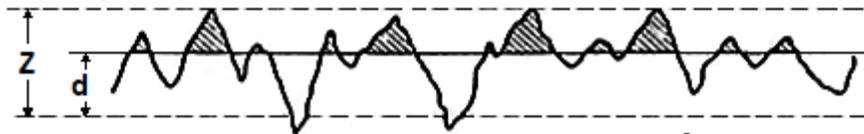
Fig. 1.7. Una superficie real penetrada por una superficie plana.
