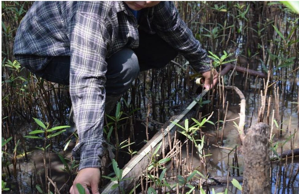
Figura 16. Medición de los intervalos para la toma de muestras para determinar densidad aparente.
