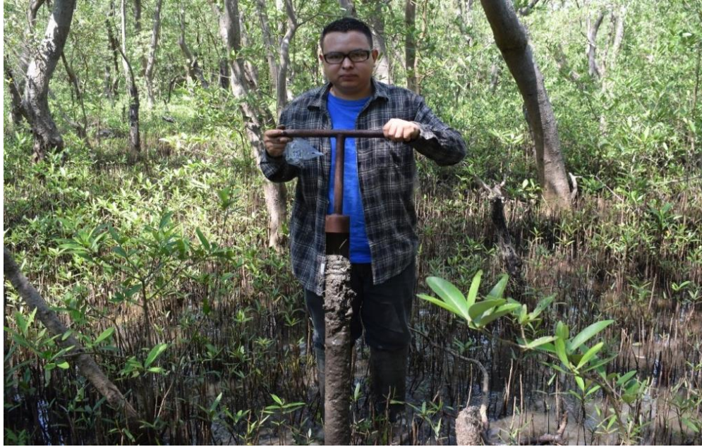
Figura 15. Extracción de suelo de manglar para toma de muestras para determinar densidad aparente y carbono orgánico total utilizando barreno para suelo no consolidado.
