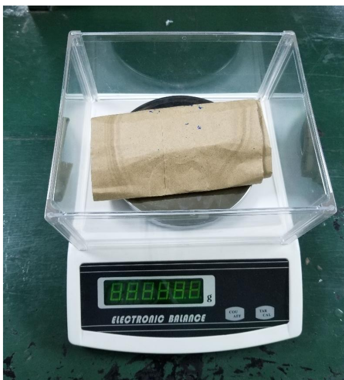
Figura 21. Toma de peso de la muestra de suelo para determinar densidad aparente, utilizando balanza analítica de alta precisión (0.01 g)
