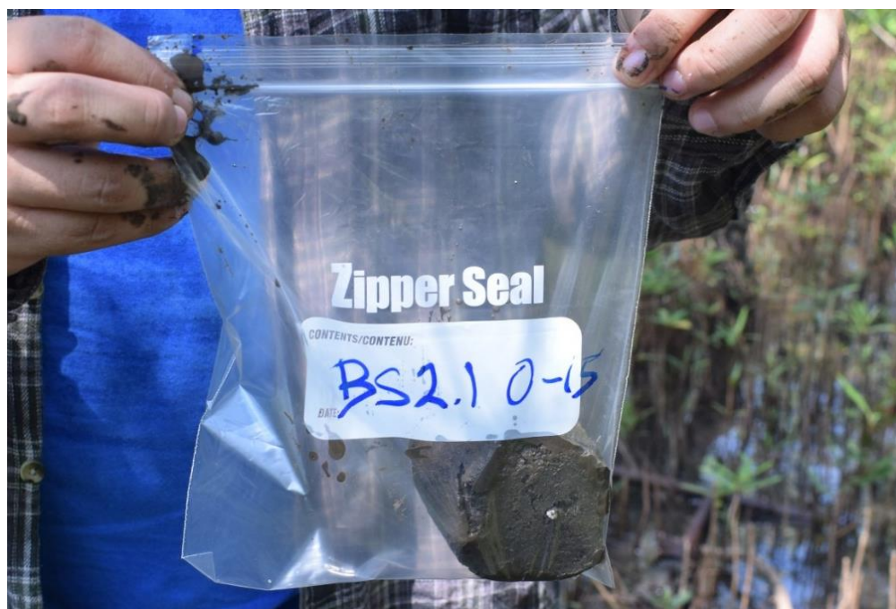
Figura 19. Almacenamiento y rotulación en campo de una muestra de suelo de manglar destinada para el análisis de densidad aparente con su respectiva rotulación y el intervalo de profundidad del suelo
