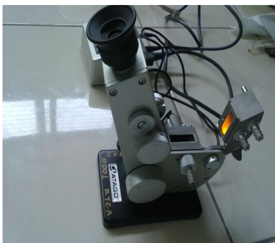
Fig. N° 14, refractómetro de ATAGO para realizar lecturas de grados Brix.
