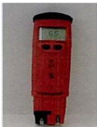
Fig. N° 11 Aparato portátil para medir el pH.
