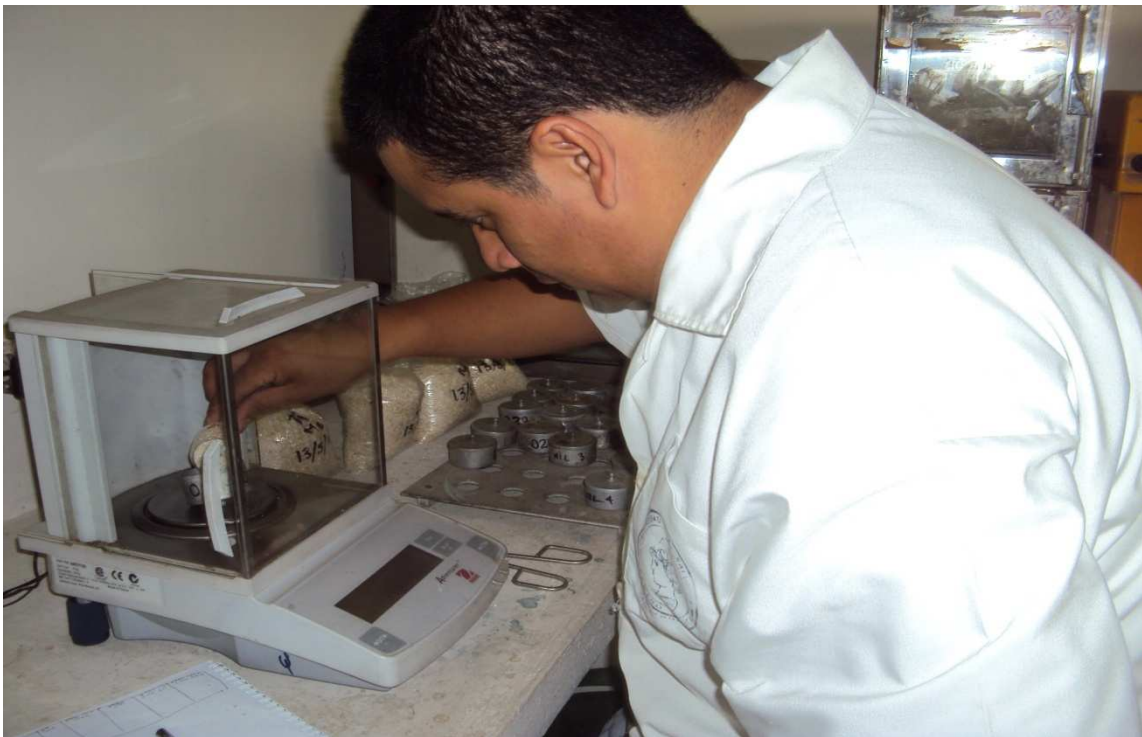
Figura A -2. Se observa la forma en cómo se coloca la muestra con cuidado en la caja de aluminio
