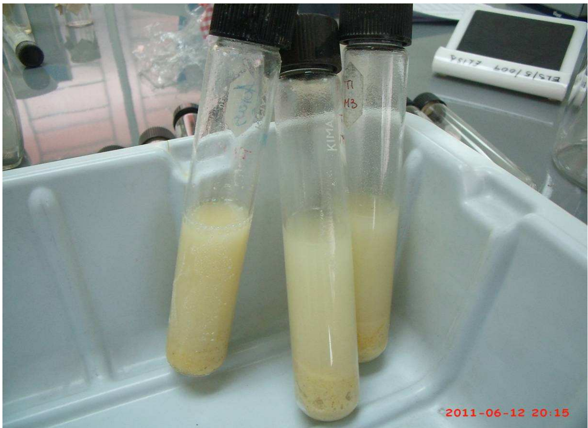
Figura A -12 Preparado de la solución de metanol al 70% mezclado en 7 partes de metanol con 3 partes de agua destilada. Con 5gr. de maíz tamizado y agitado por 3 minutos.
