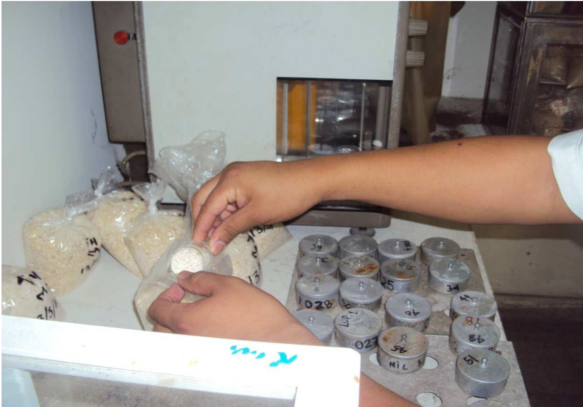
Figura A -3. Se observa el medidor para tomar la muestra y las cajas de aluminio para humedad donde se colocan las muestras
