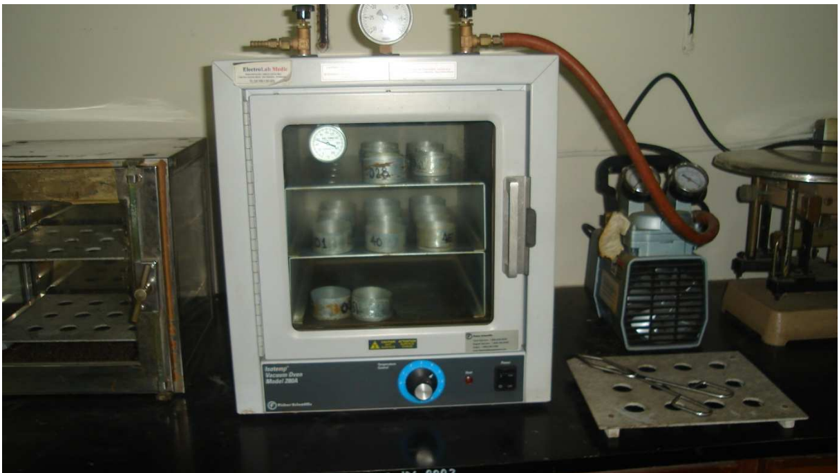
Figura A -6. Estufa de aire reforzado o ventilación forzada previamente calibrada a 70 °C.
