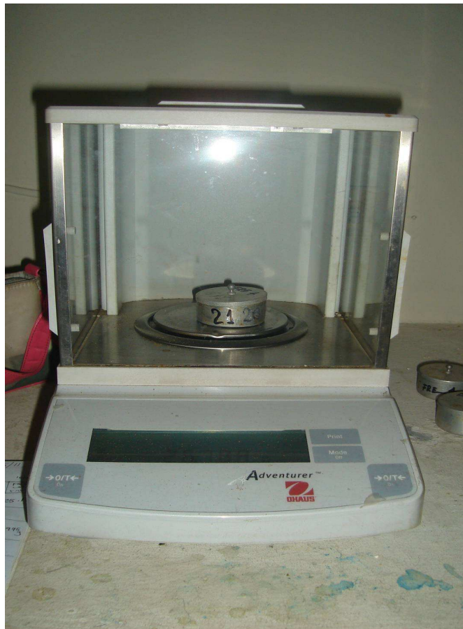
Figura A -8. Cajas de aluminio conteniendo la muestra ya habiéndole extraído la humedad.
