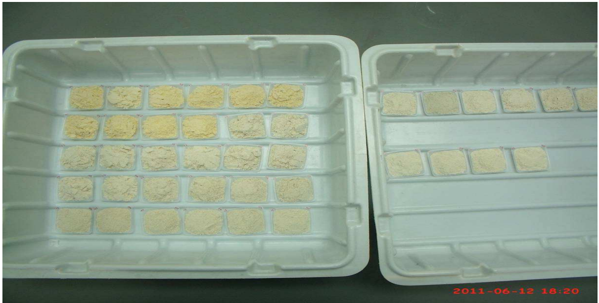
Figura A -11. Maíz triturado y ya tamizado a través de una malla número 20 con aspecto de café molido instantáneo.
