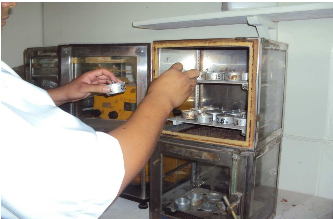
Figura A -4. Se observa cómo se colocan las cajas que contienen la muestra en el desecador de aire circulante.
