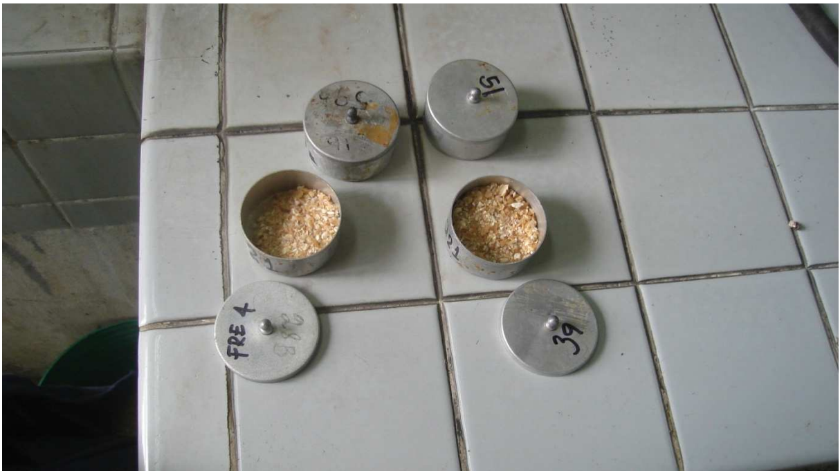
Figura A -8. Cajas de aluminio conteniendo la muestra ya habiéndole extraído la humedad.
