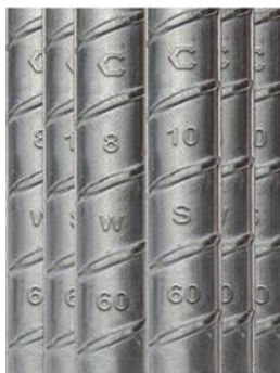
Figura 3. 3 Acero de refuerzo.
