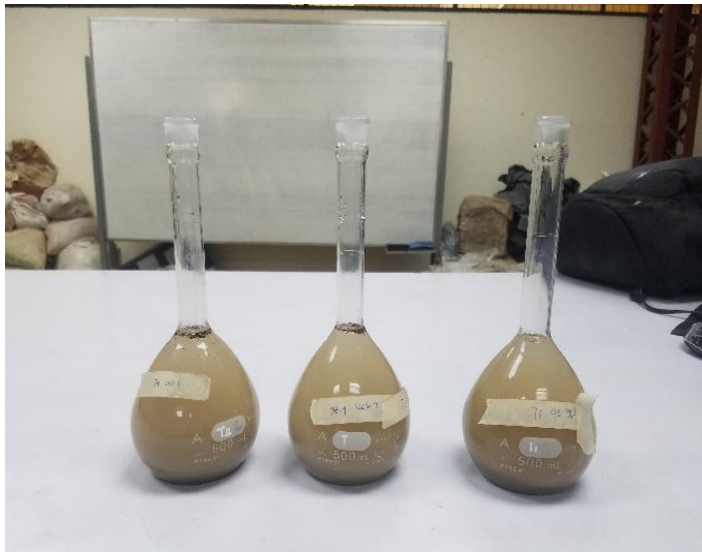
Figura No.4.16 Ejecución de ensayo de gravedad específica, picnómetros con lechadas correspondientes a las unidades G y F del talud Padre Arrupe.
