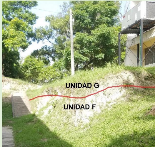
Figura No.4. 6 Estratigrafía Talud Civil.
