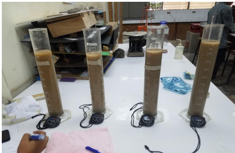
Figura No.4.13 Toma de lecturas del hidrómetro, de posibles unidades ignimbrita alfa e ignimbrita beta de TBJ, talud Padre Arrupe.
