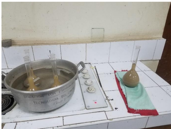
Figura No.4.17 Ejecución de ensayo de gravedad específica, desaireación de las lechadas de las unidades G y F correspondientes al talud Padre Arrupe.
