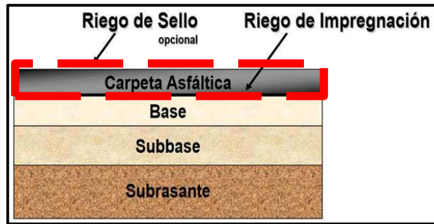
Figura 13: Carpeta Asfáltica o Carpeta de Rodadura, corte transversal.
