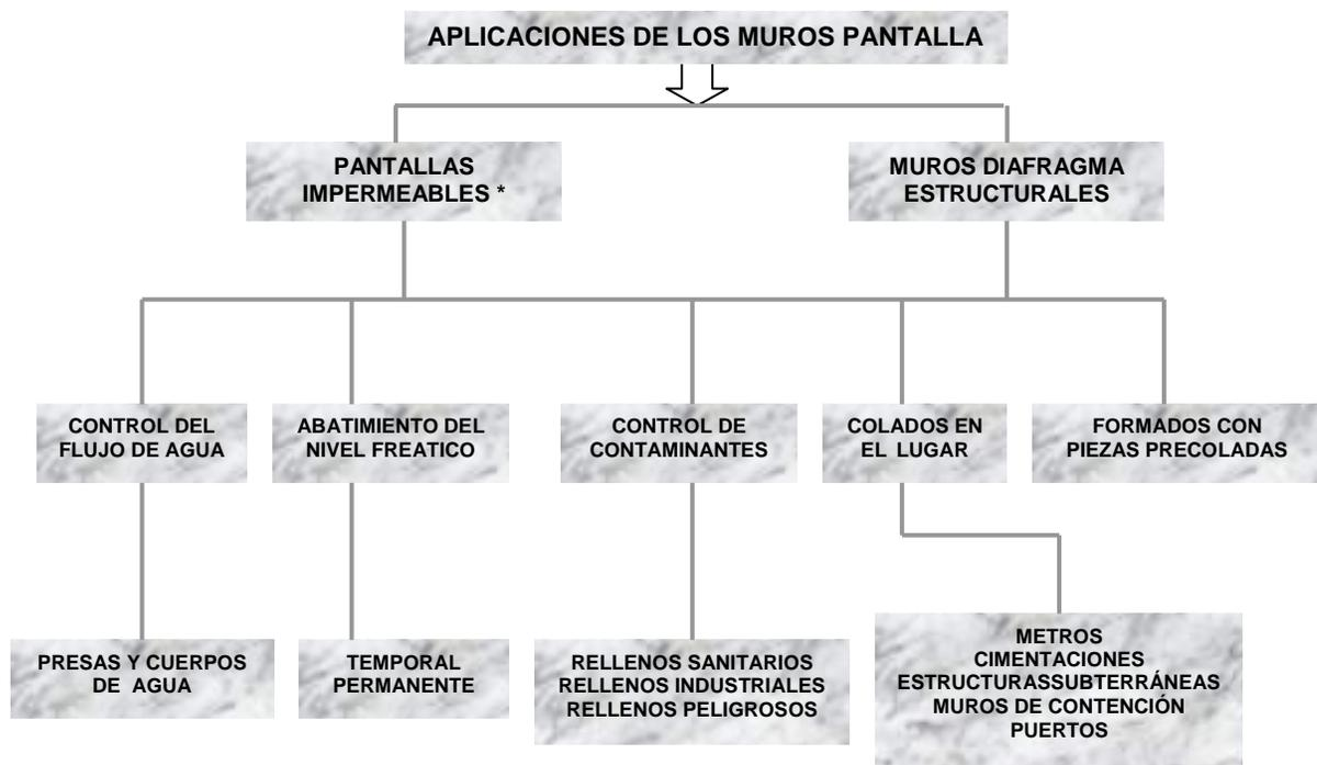
Esquema 5.1 Campos de aplicación de los muro pantalla
