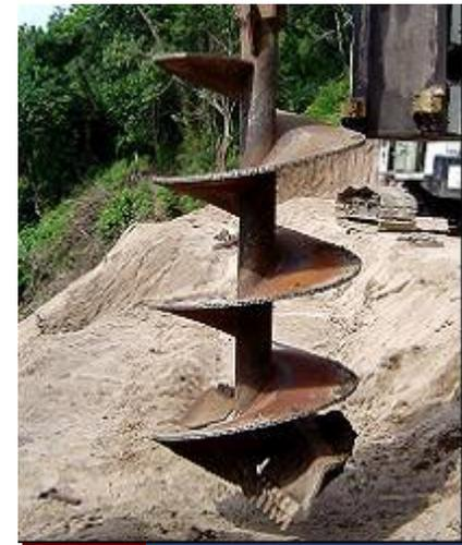
Figura 2.11 Barreno (hólices en espiral)
