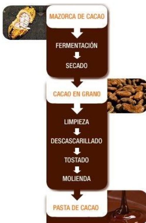
Figura 1. Flujo de proceso de pasta de cacao.
