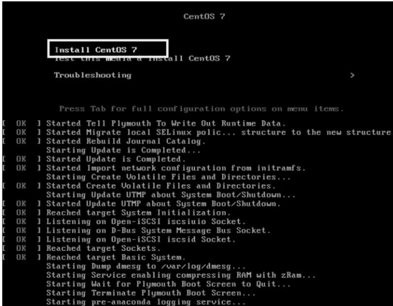
Figura 11. Ejecutar Imagen de Instalación CentOS 7
