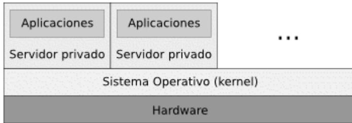
Figura 4. Estructura de Virtualización por Sistema Operativo
