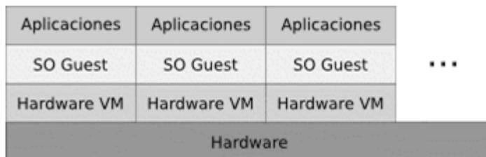
Figura 1. Estructura de Virtualización de Hardware
