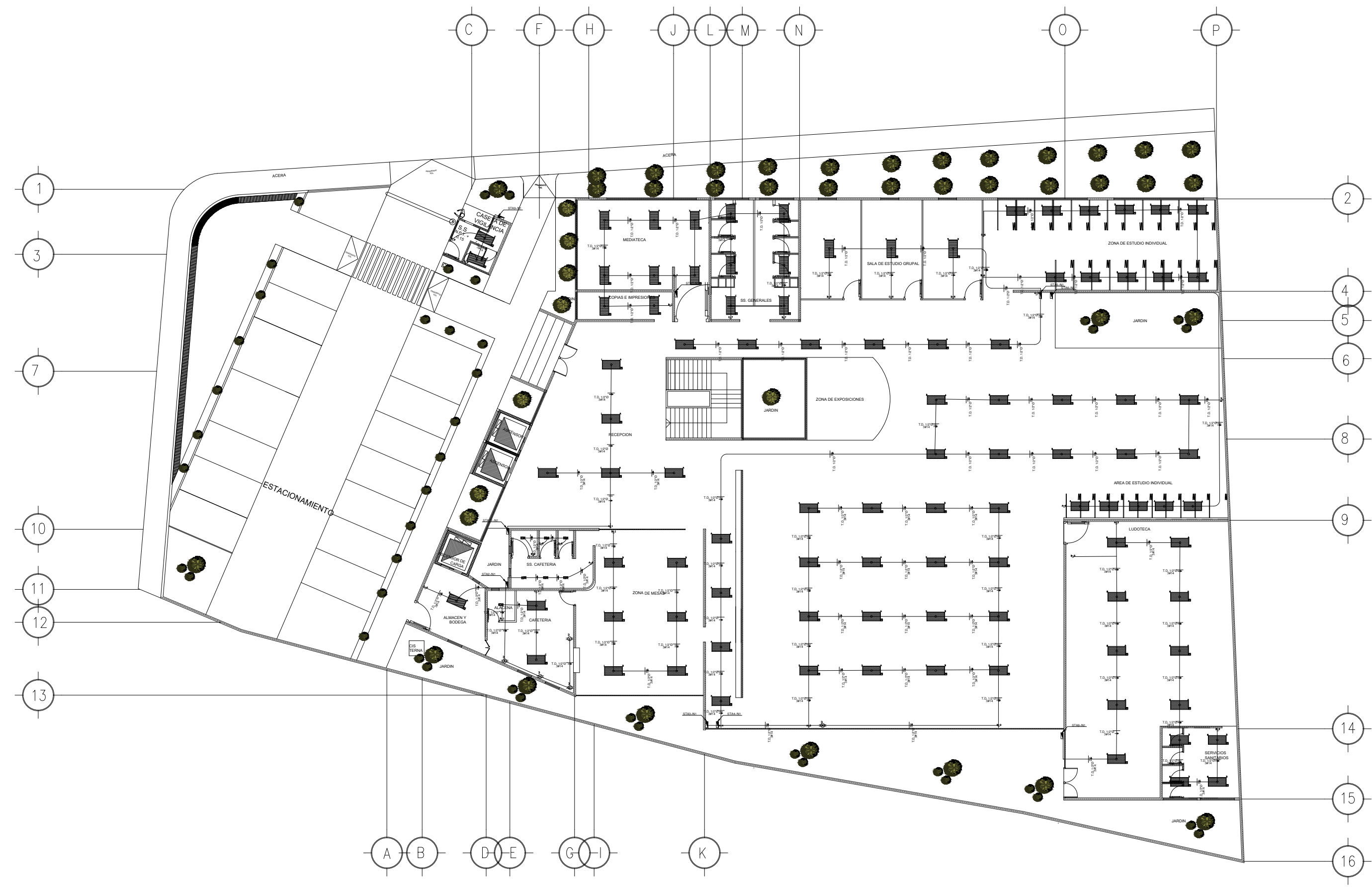
PLANTA DE INSTALACIÓN ELÉCTRICA NIVEL 1 ESC. 1:250
