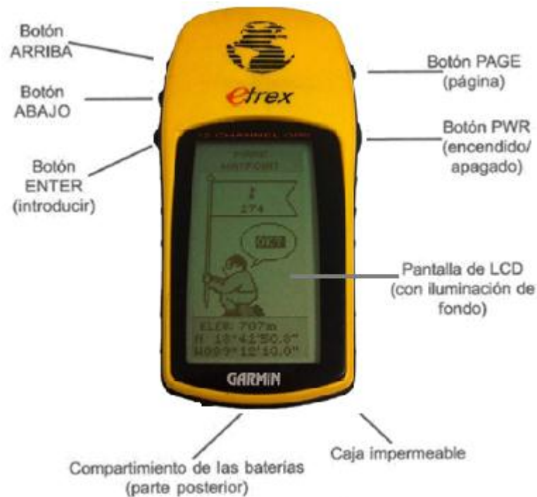
FIGURA N°7. DESCRIPCIÓN DE LOS BOTONES DEL SISTEMA DE POSICIONAMIENTO GLOBAL (GPS)
