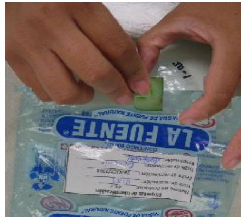
(c) Eliminar del plástico cualquier letra con algodón impregnado con alcohol
