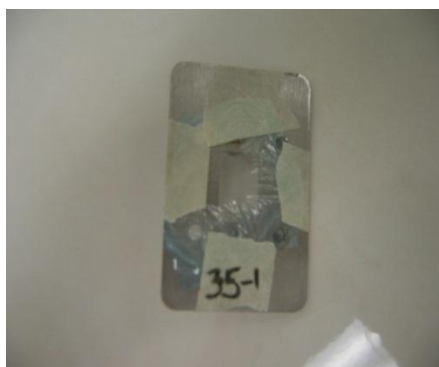
(g) Pegar el plástico cortado en la celda con tirro.
