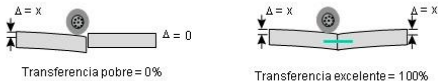
Figura 4.18 Transferencia de Carga. Fuente: Sacada de internet
