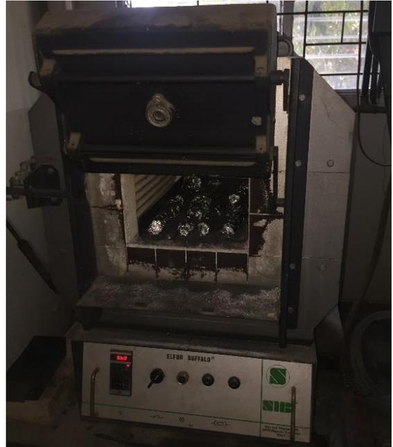
Fig. 2.10. Colocación del lote de probetas en la cámara del horno para el tratamiento de recocido.
