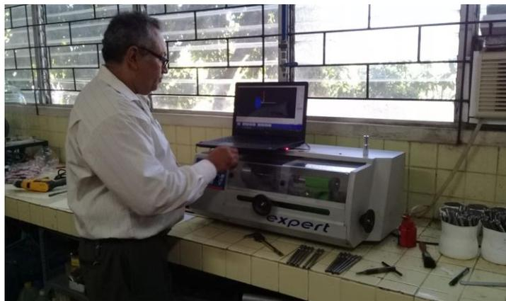
Fig. 2.7. Torno CNC marca ALECOP, modelo Expert.
