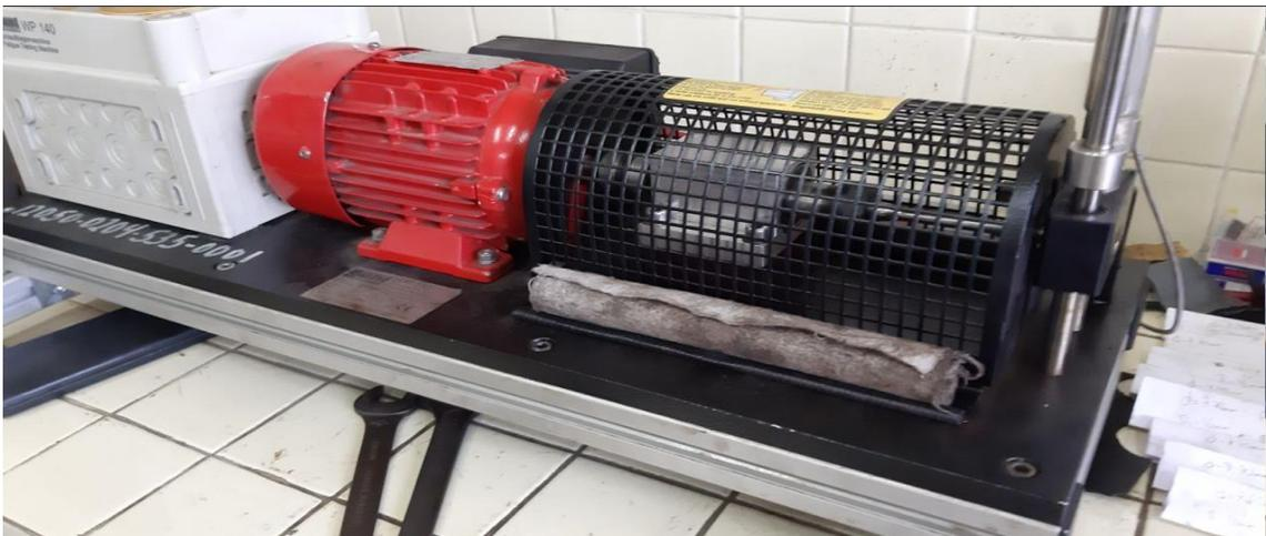
Fig. 2.15. Máquina de fatiga por flexión rotativa en funcionamiento.
