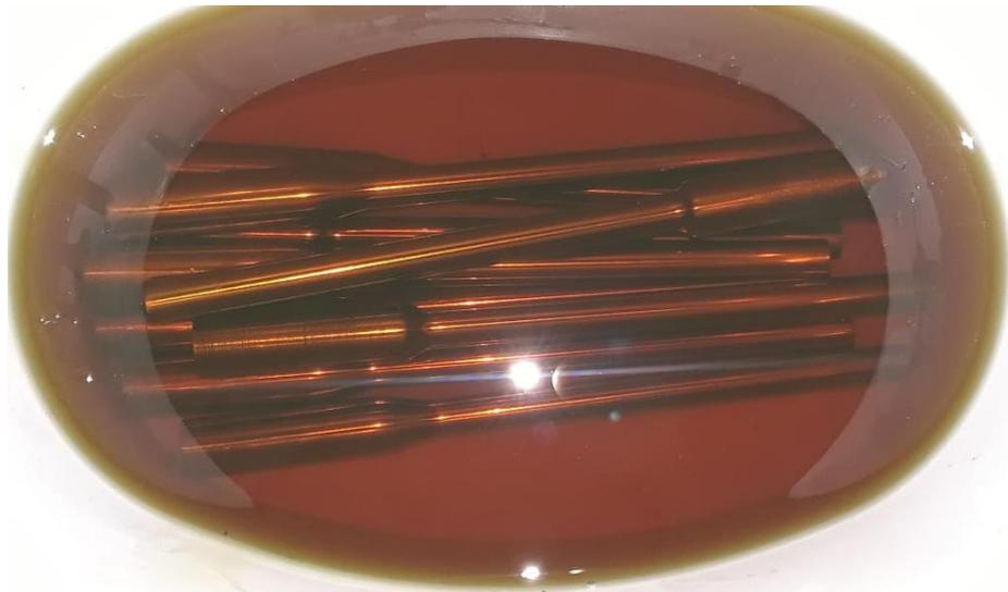
Fig. 2.13. Probetas pulidas y depositadas en recipientes con aceite mineral para evitar corrosión.
