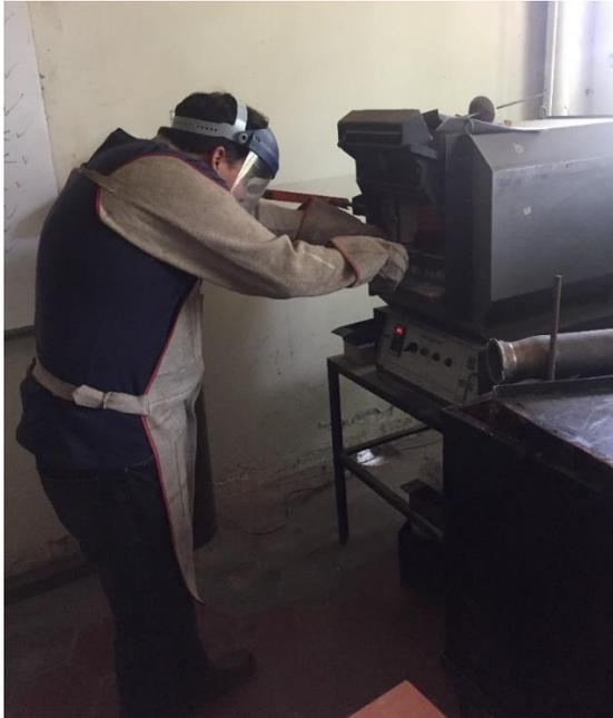
Fig. 2.9. Equipo de protección para el proceso de tratamiento térmico recocido.
