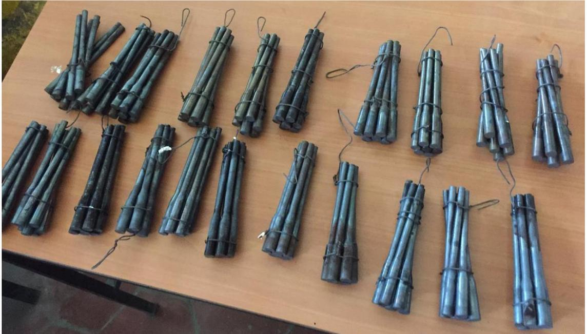
Fig. 2.11. Probetas de Acero AISI 1020 maquinadas y recocidas.
