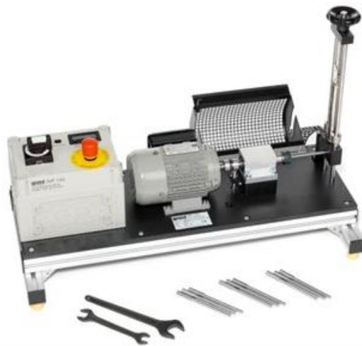
Fig. 2.2. Máquina de fatiga por flexión rotativa con soporte simple.
