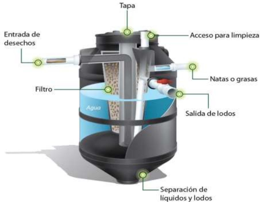
Figura 4.4. Esquema de funcionamiento de un Biodigestor (ROTOPLAS, 2020).
