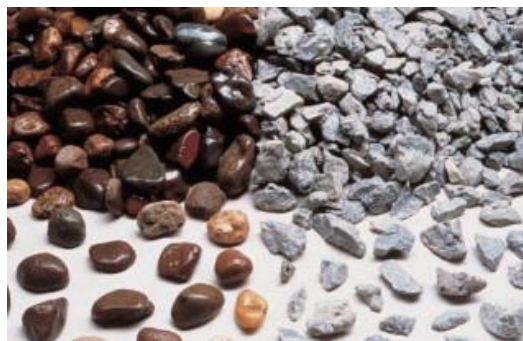
Figura No.2.2: Agregado grueso. Grava redondeada (izquierda) y piedra triturada (derecha).
